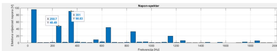
Slika 6.26. Harmonijski sadržaj linijskog napona
