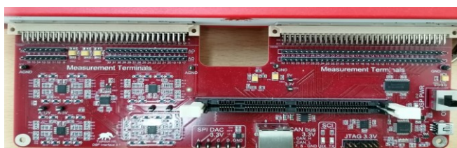
Slika 5.4. Vanjsko sučelje s IN/OUT pinovima
