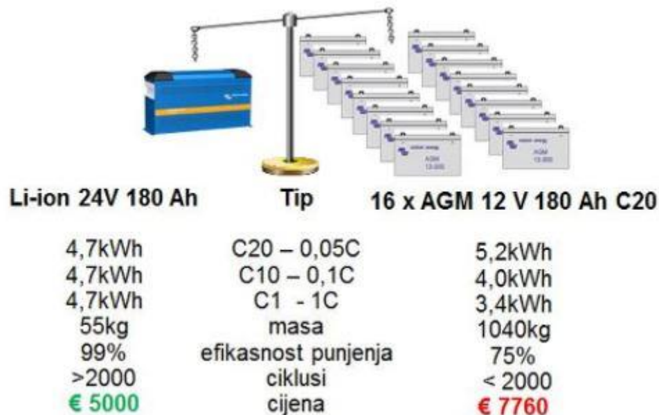
Slika 4.4 Usporedba dvije vrste baterija [14]
