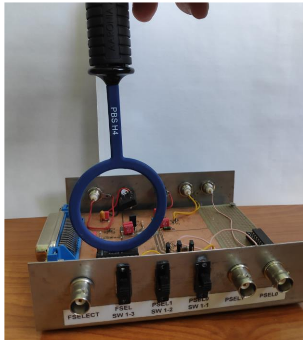
Sl. 4.11. Primjer mjerenja električne komponente magnetskom sondom PBS-H4
