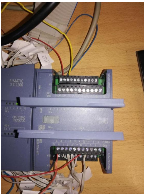
Slika 3.2.: Signalni modul SM 1223 DI16/DQ16
