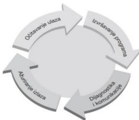
Slika 2.2.: Prikaz cikličkog izvršavanja programa [4]
