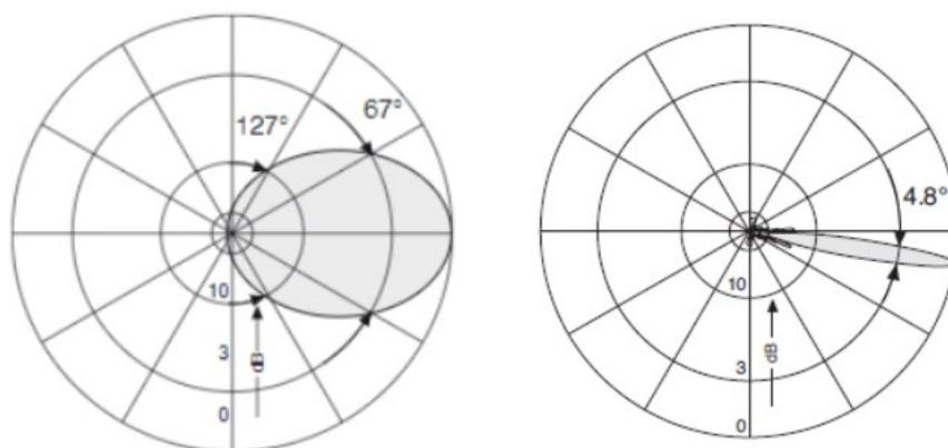
*Slika 4.5. Dijagrami zračenja u horizontalnoj i vertikalnoj ravnini antene sličnih parametara kao antena CMA-UBTLBHH/6517/21/21 za područje od 1710 MHz do 2690 MHz [13]*
