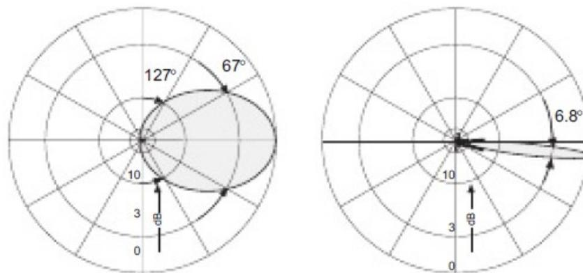
*Slika 4.10. Dijagrami zračenja u horizontalnoj i vertikalnoj ravnini antene 742 215 za područje od 1710 MHz do 1880 MHz [15]*
