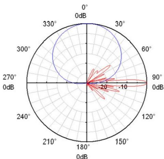
Slika 4.9. Dijagrami zračenja u horizontalnoj i vertikalnoj ravnini antene ATR451606 za područje od 1710 MHz do 2690 MHz [14]
