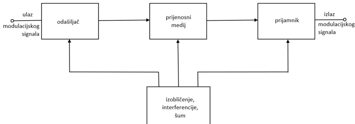
*Slika 1.1. Grafički prikaz radiokomunikacijskog sustava*
