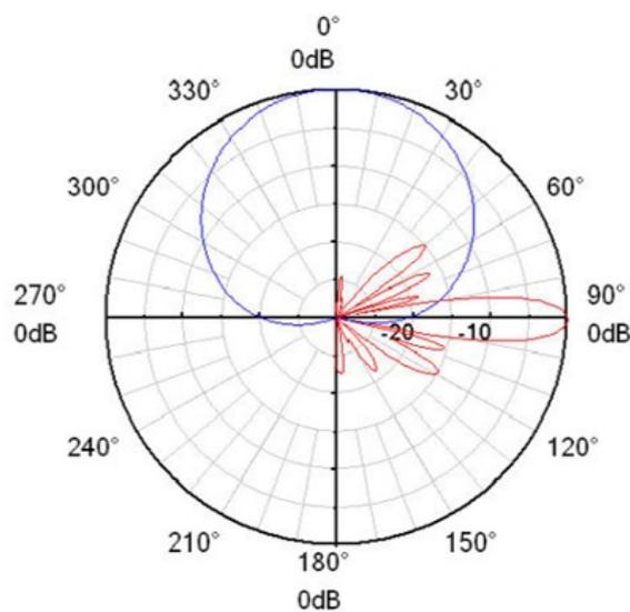
*Slika 4.7. Dijagrami zračenja u horizontalnoj i vertikalnoj ravnini antene ATR451606 za područje od 790 MHz do 960 MHz [14]*
