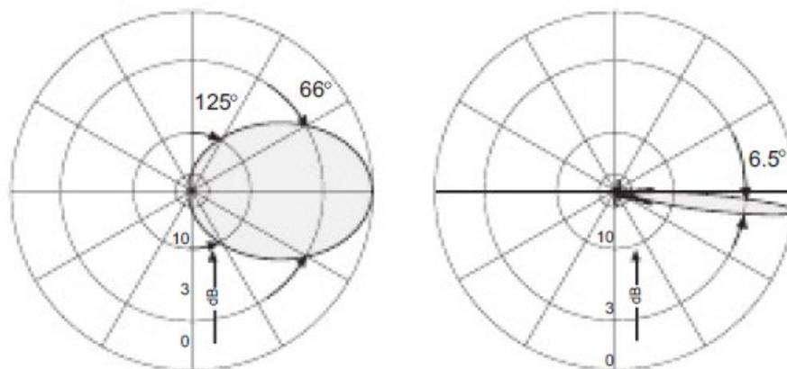
Slika 4.11. Dijagrami zračenja u horizontalnoj i vertikalnoj ravnini antene 742 215 za područje od 1850 MHz do 1990 MHz [15]
