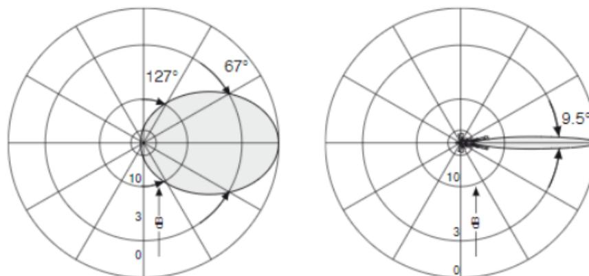
*Slika 4.4. Dijagrami zračenja u horizontalnoj i vertikalnoj ravnini antene sličnih parametara kao antena CMA-UBTLBHH/6517/21/21 za područje od 1710 MHz do 2690 MHz [13]*
