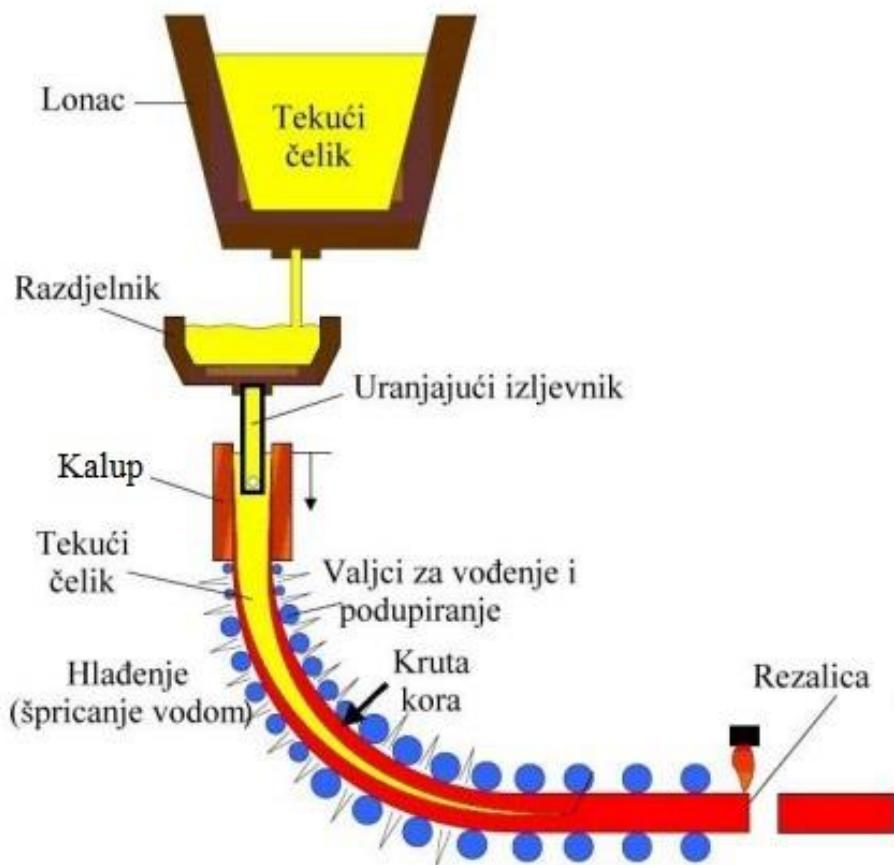
Slika 2.1. Načelna shema postrojenja za kontinuirano lijevanje čelika.
