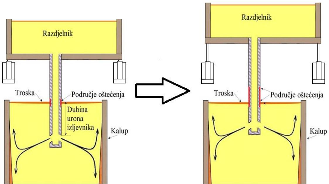
**Slika 2.8.** Vertikalni pomak razdjelnika i uranjajućeg izljevnika.
