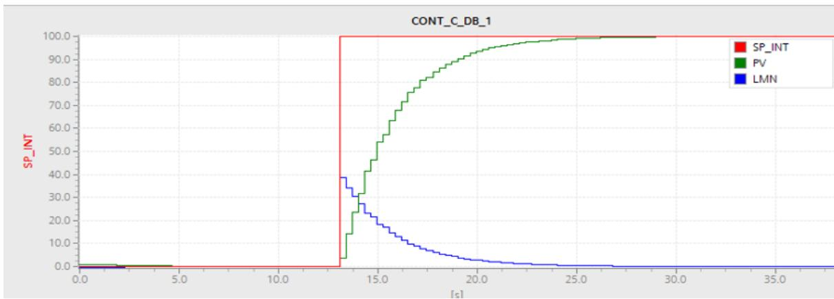
**Slika 4.6.** Namještanje pozicije cilindra pomoću PID regulatora.
