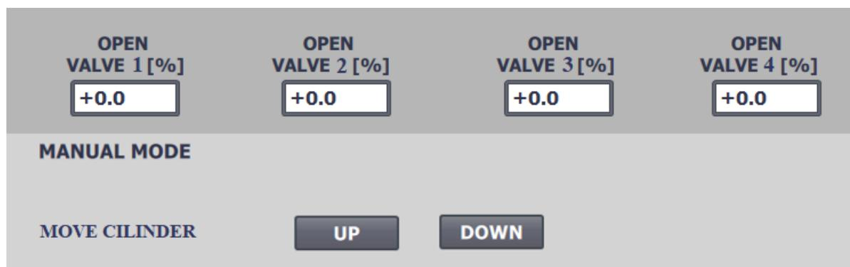
**Slika 3.9.** Ručni način rada u sučelju čovjek-stroj.
