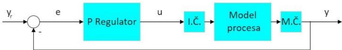
**Slika 3.5.** Načelna shema simulacije eksperimenta metode ruba stabilnosti
