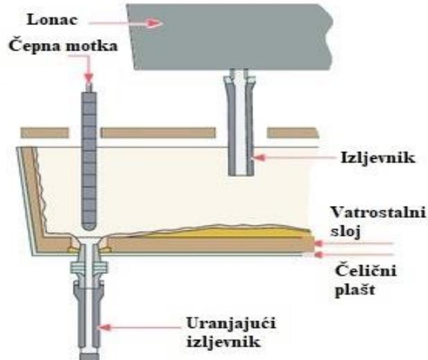
**Slika 2.5.** Dijelovi razdjelnika.
