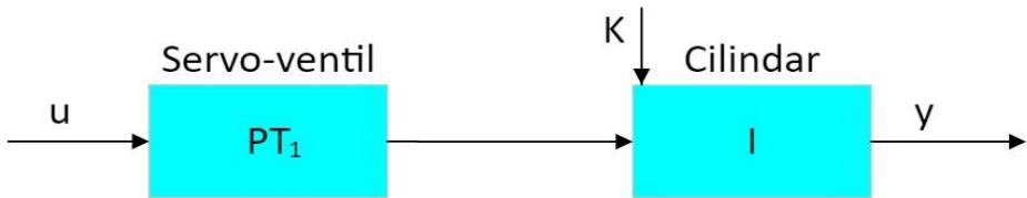
**Slika 3.4.** Model procesa za podešavanje parametara PI regulatora.
