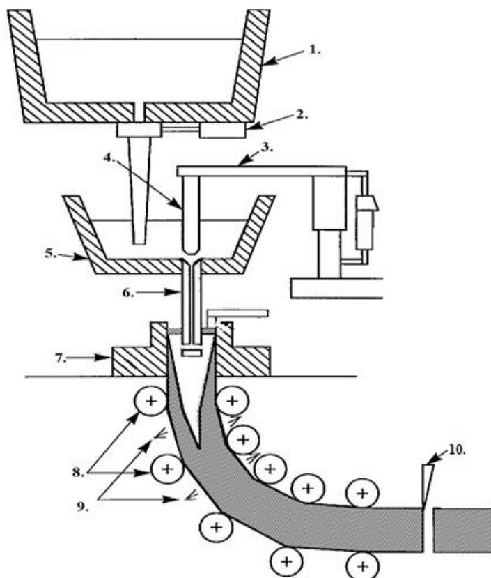
Slika 2.4. Načelna shema procesa zakriviljenog kontinuiranog lijevanja.
