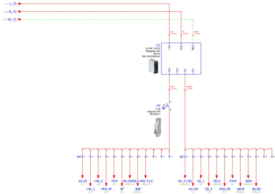
Sl. 2.24 Električna shema spajanja napajanje 24 VDC
