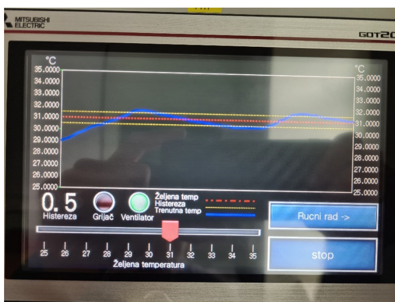
Sl. 4.7 HMI panel u prvoj opciji automatskog rada
