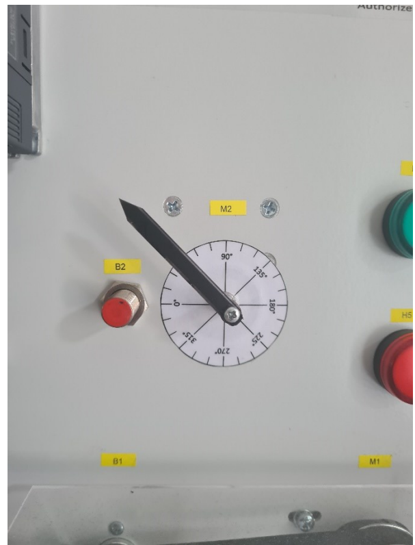
Sl 4.26 Pozicija servomotora nakon pokretanja za 45°
