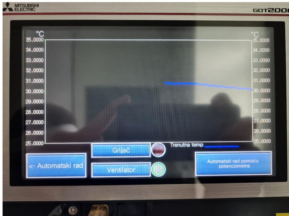
Sl. 4.8 HMI panel u ručnom načinu rada
