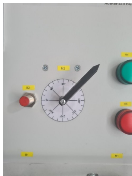
Sl 4.20 Pozicija servomotora nakon pokretanja za 180°
