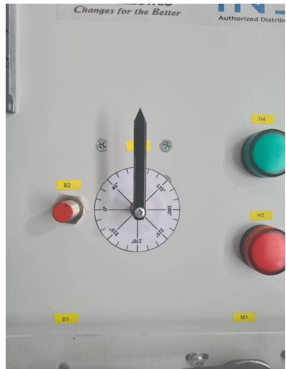
Sl 4.23 Pozicija servomotora nakon pokretanja za 90°
