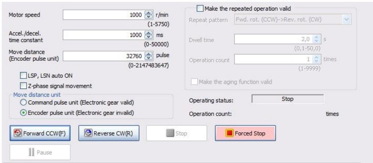
Sl 4.21 *Positioning Mode* pri brzini vrtnje motora od 1000 r/min, vrijeme ubrzanja/usporenja od 1000 ms i pomaka od 32760 pulseva (90°)
