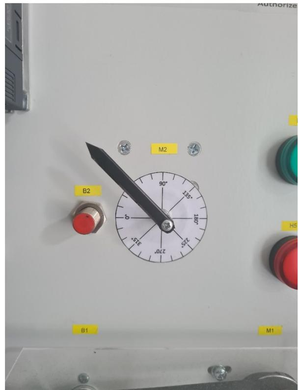
Sl 4.26 Pozicija servomotora nakon pokretanja za 45°
