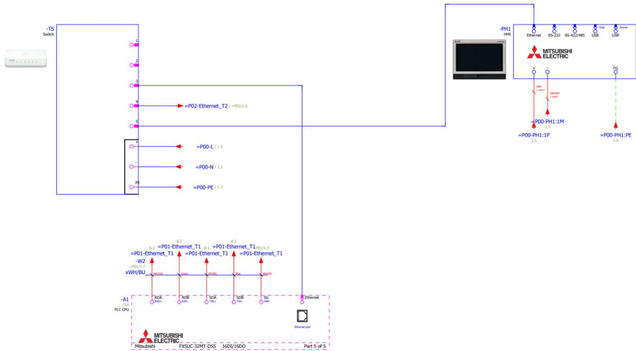
Sl. 2.21 Električna shema spajanja HMI GOT2000 panela [4]
