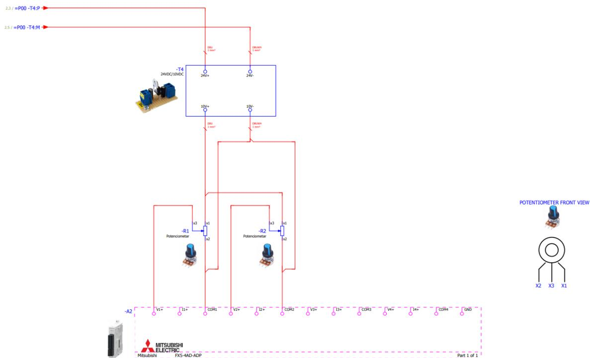
S1. 2.12 Električna shema spajanja potenciometra na FX5-4AD-ADP [4]
