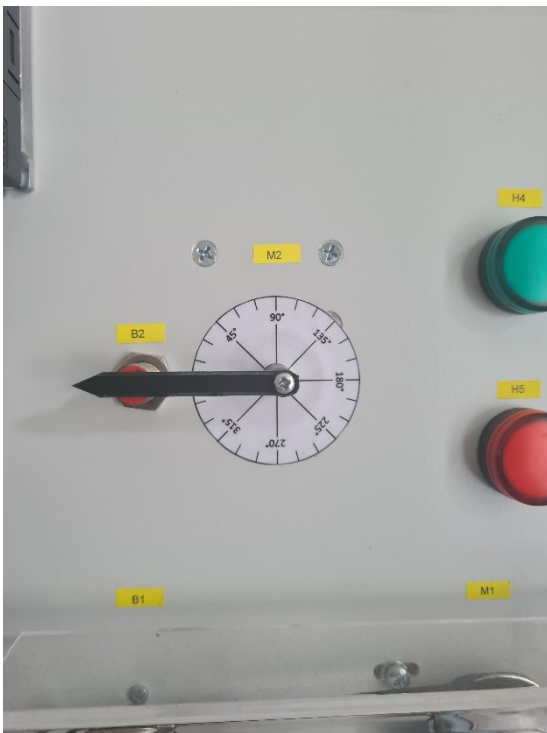
Sl 4.22 Pozicija servomotora prije pokretanja za 90°
