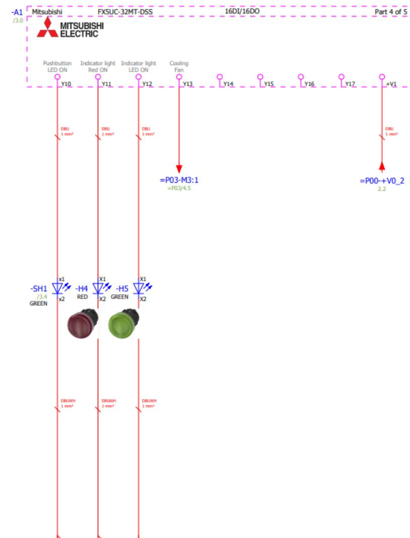
Sl. 2.10 Električna shema spajanja LED svjetla i ventilatora na FX5UC [4]
