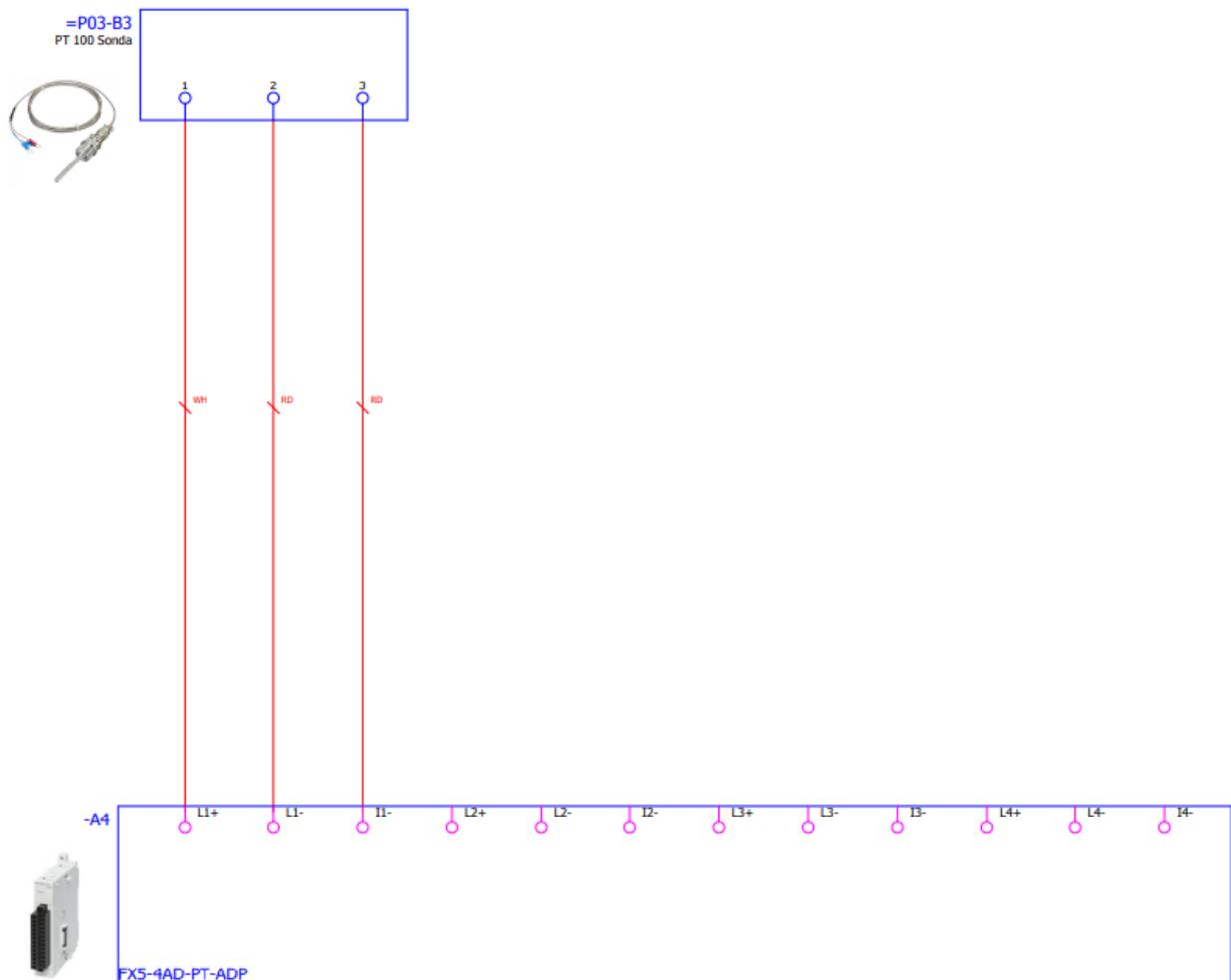
Sl. 2.14 Električna shema spajanja Pt100 sonde na FX5-4AD-PT-ADP [4]
