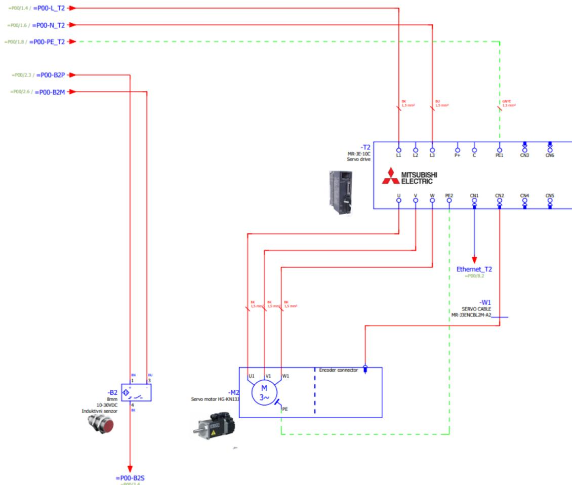
Sl. 2.20 Električna shema spajanja MR-JE-10C i HG-KN13J [4]
