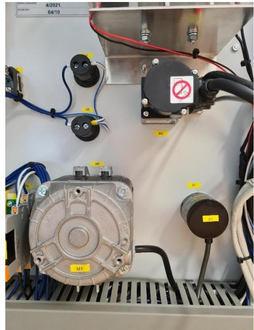
Sl. 2.16 Asinkroni motor i enkoder
