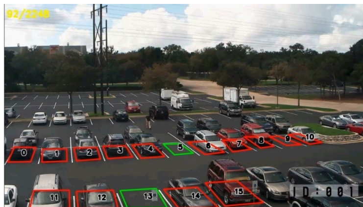
Slika 2.4 Uporaba kamere za upravljanje parkingom, [8]
