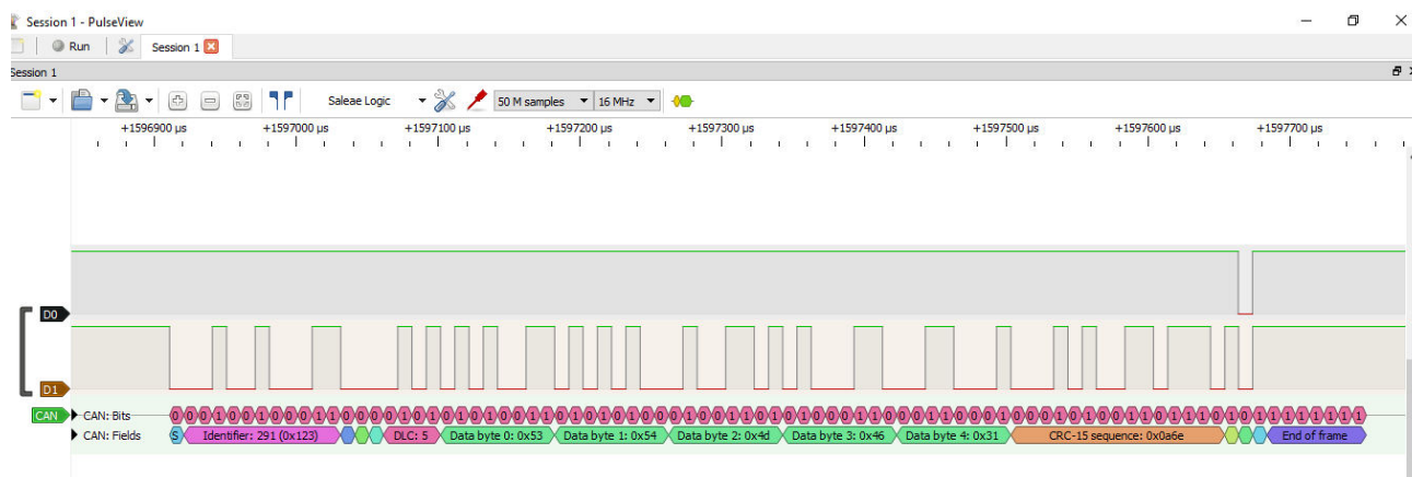
Slika 4.10. Izgled jednog CAN okvira
