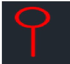
SI.4.4. Izvod za priključenje jednofaznog trošila
