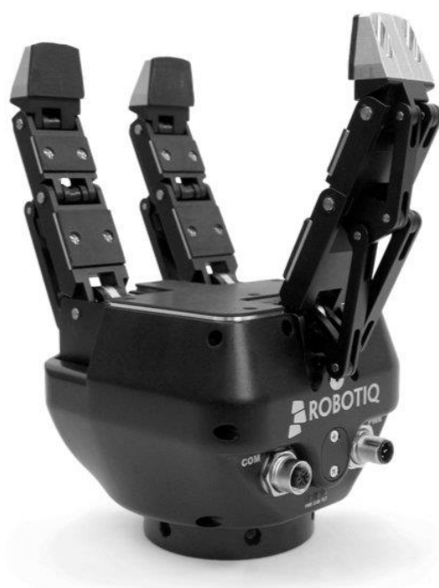
Slika 3.2 Robotiq 3-finger gripper
