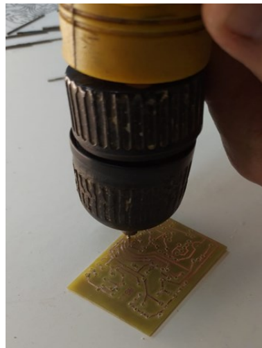
Slika 4.6 Bušenje rupa na predviđenim mjestima
