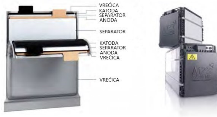
Slika 4.3. Osnovni Li-ion dizajn u obliku prizme i baterijski moduli [11]
