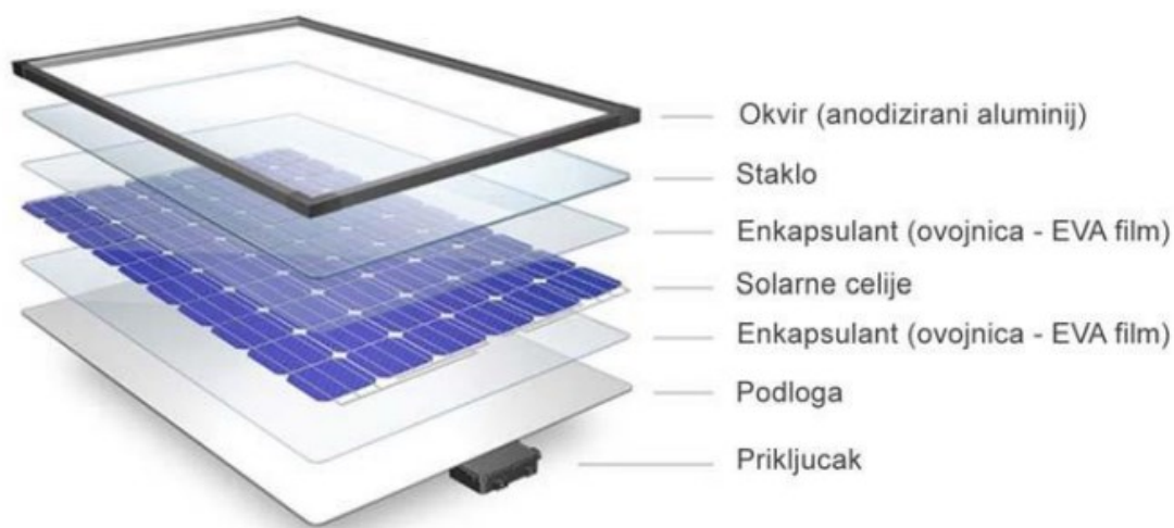
Slika 3.2. Struktura fotonaponske ćelije [16]
