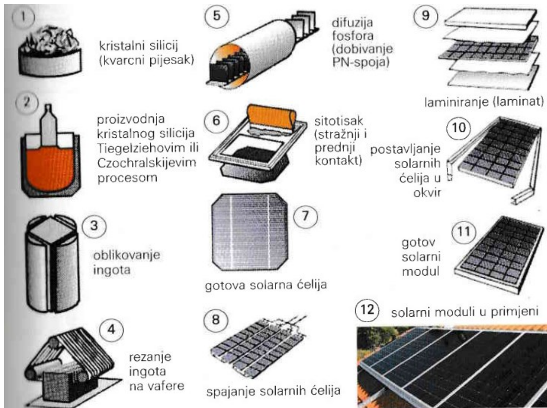
Slika 3.4. Postupak proizvodnje fotonaponskih ćelija i fotonaponskog modula [4]
