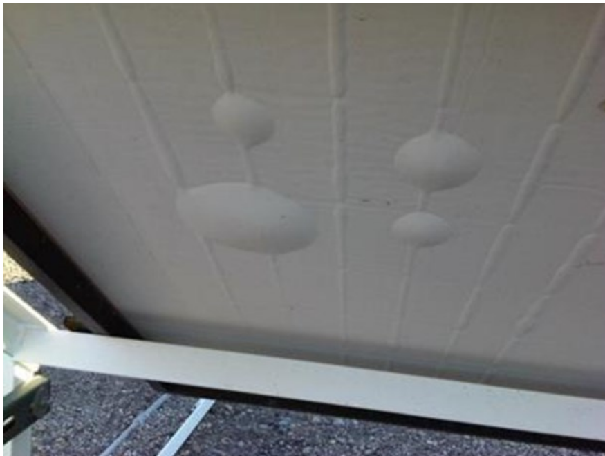
Slika 4.3. Delaminacija stražnje strane modula [8]
