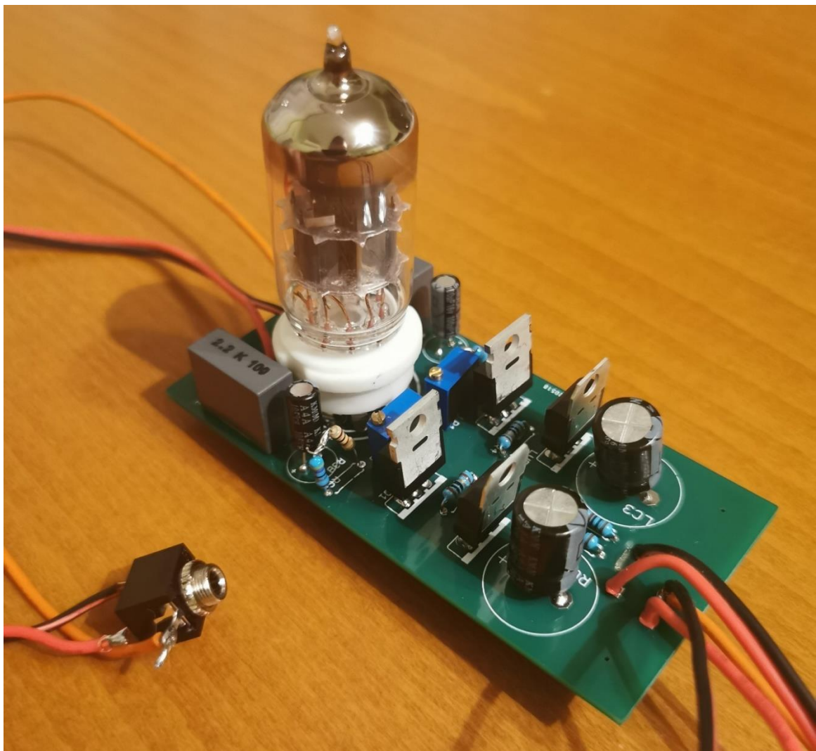
Slika 4.6: Pojačalo sa zalemljenim komponentama
