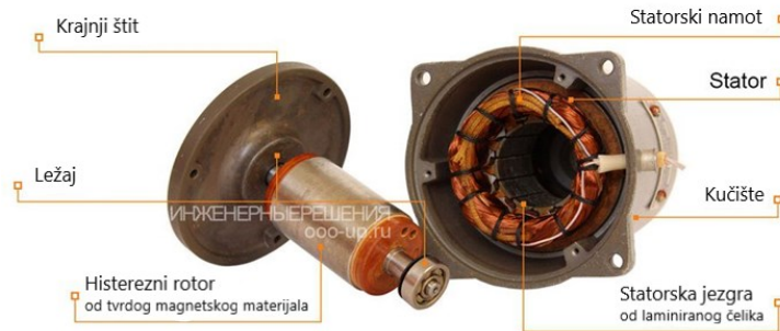
Slika 3.4 Histerezni motor [10]
