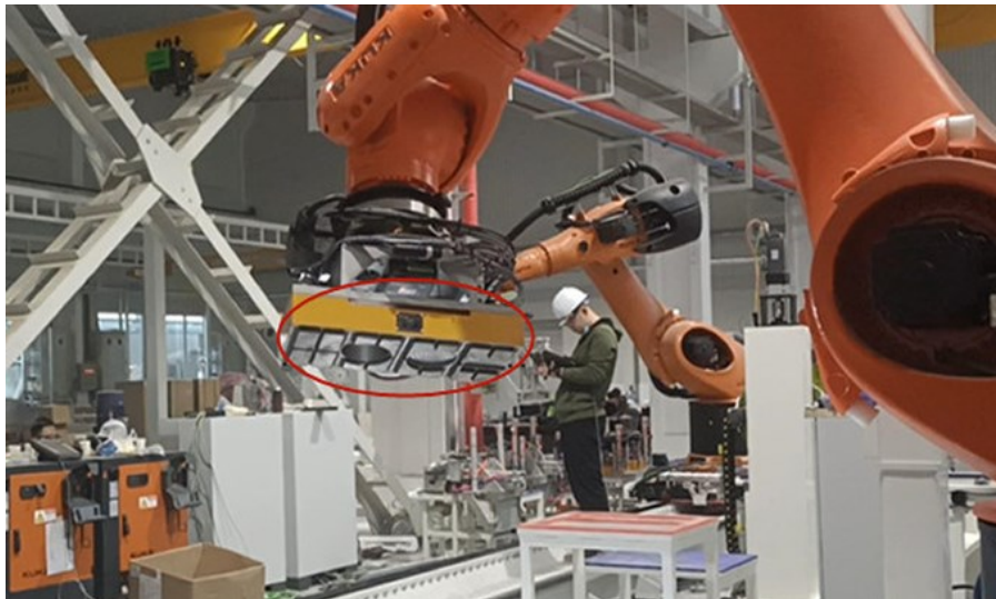
Slika 5.20. Magnetska hvataljka na robot [23]
