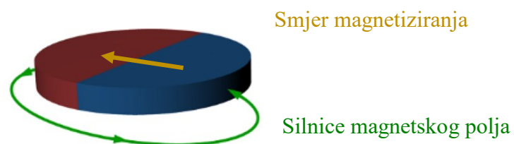
Slika 5.16. Radijalno magnetiziran magnet [22]
