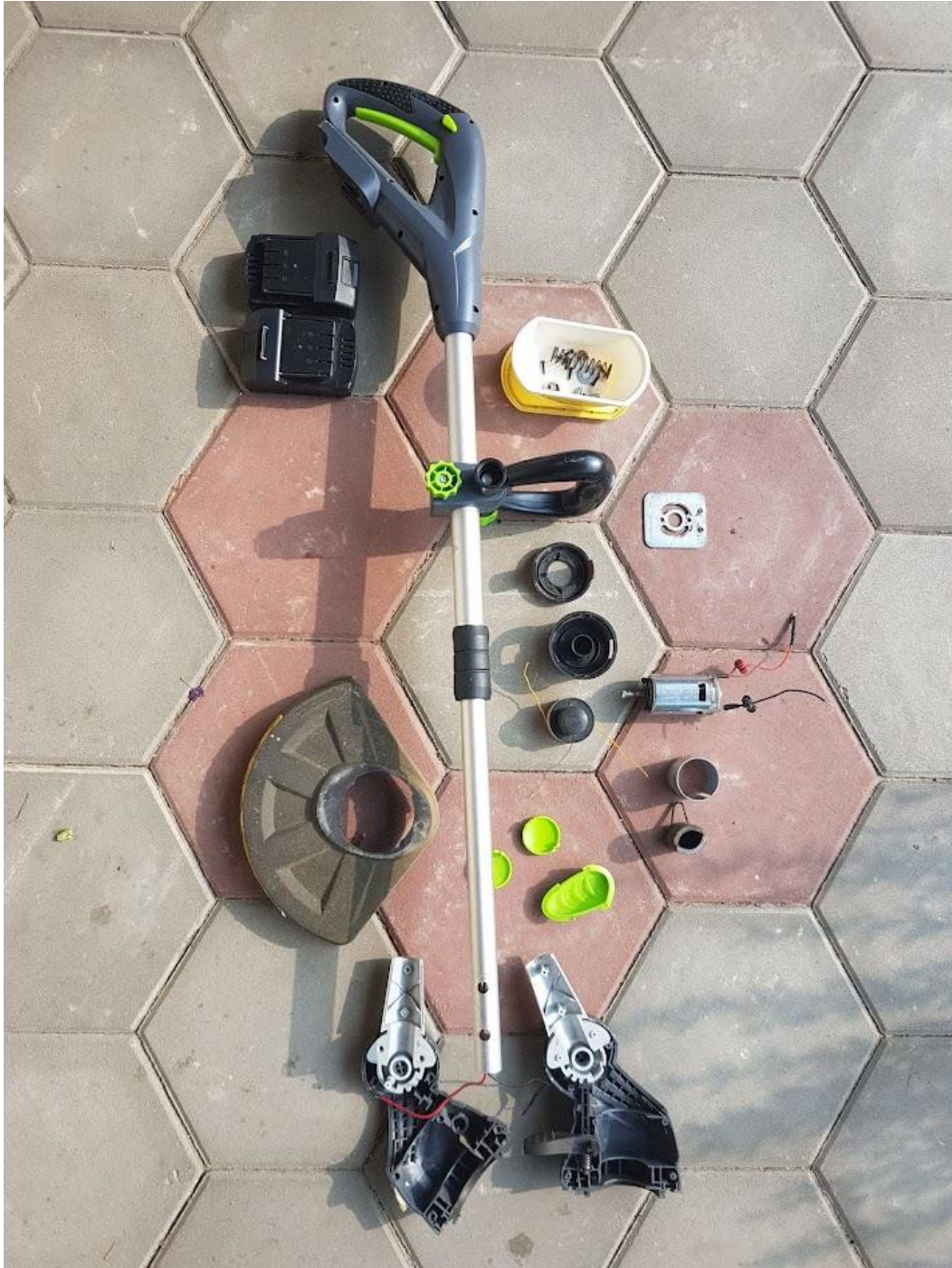
Sl. 5.2. Postupak rastavljanja električnog trimera
