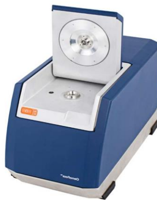
Sl. 2.3. Laboratorijski instrument za mjerenje parametara vina tvrtke Foss, model OenoFoss™.
