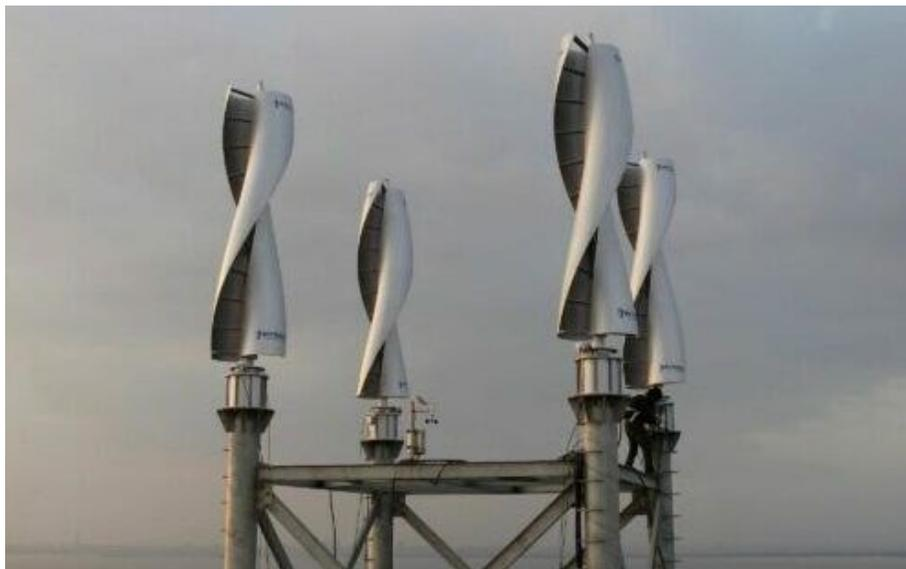
*Slika 2.1.4. Primjer spiralne konstrukcije Savonius turbine [5]*
