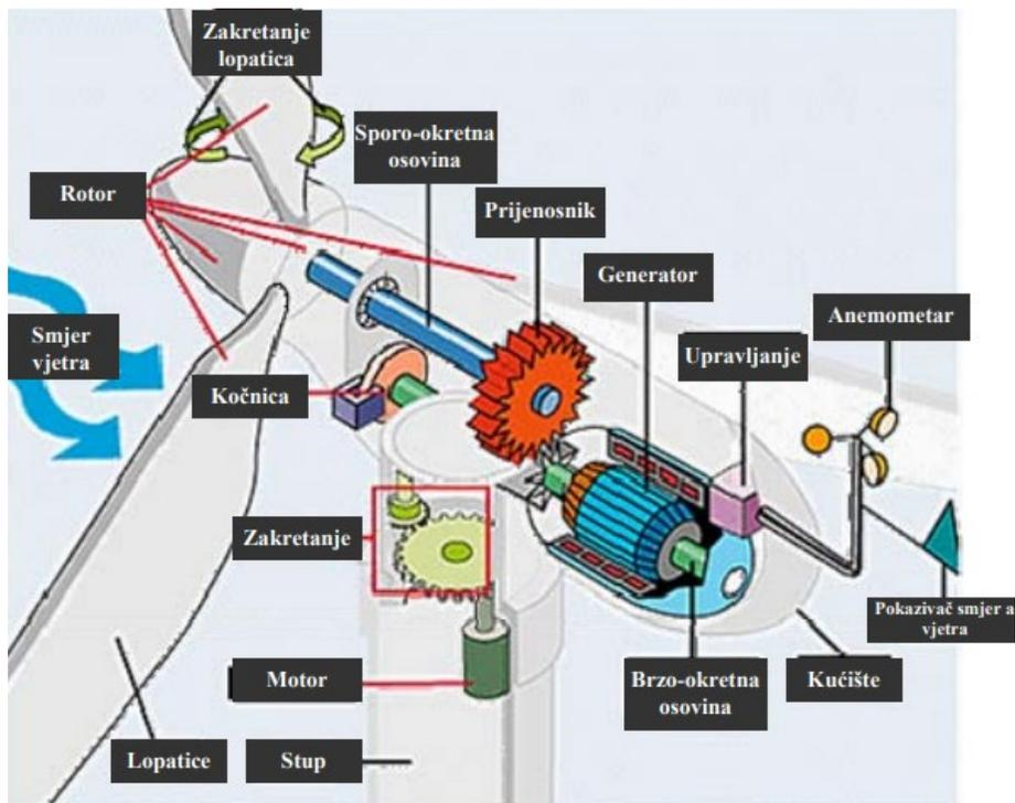
**Slika 4.1. Konstrukcija i osnovni dijelovi vjetroagregata [11]**
