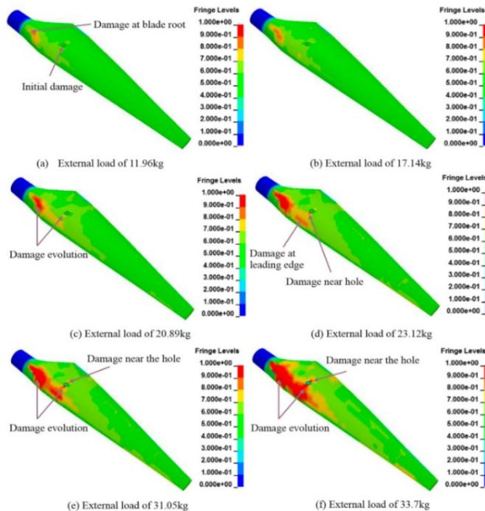
*Slika 4.3.7.2. Oštećenje lopatica vjetroagregata uslijed opterećenja [21]*
