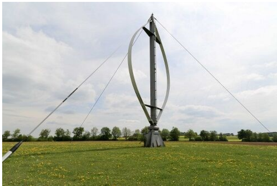
Slika 2.1.5. Primjer Darrieusovog tipa vjetroagregata [5]
