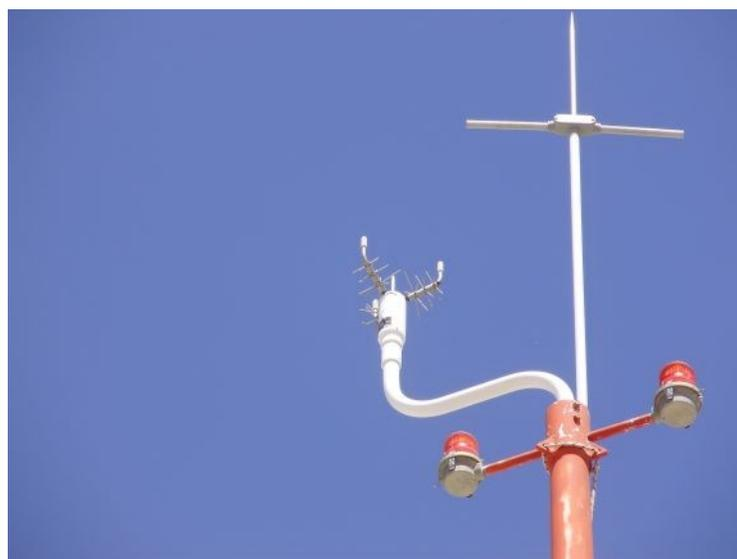
*Slika 3.2. Zvučni anemometar [7]*
