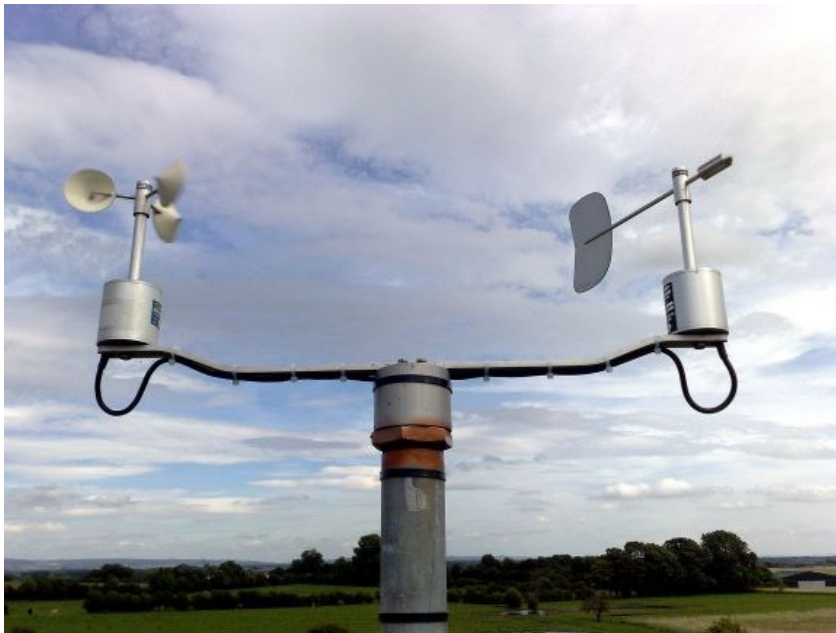
Slika 3.1. Anemometar s lopaticama [7]
