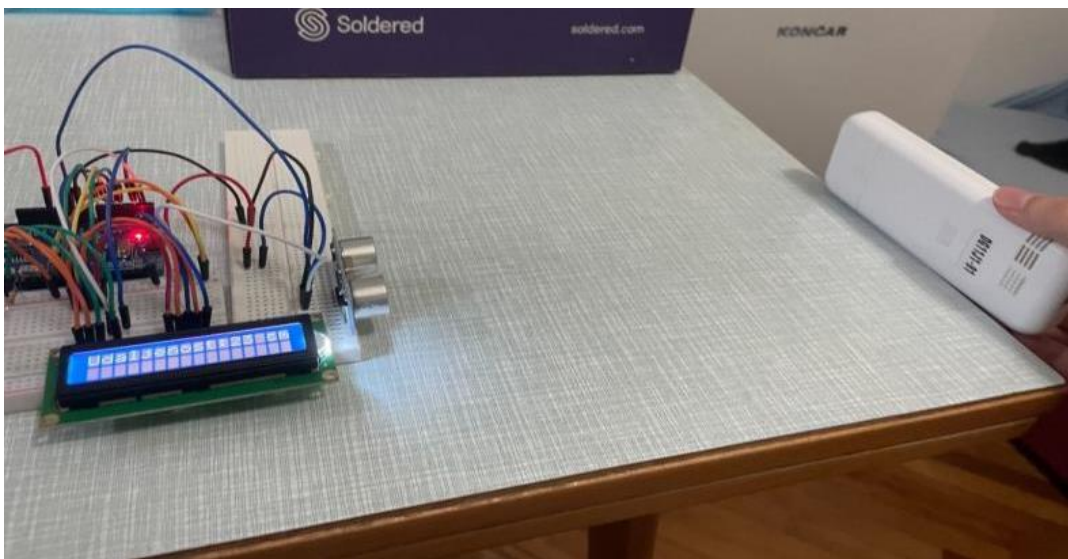
Slika 4.22. Prikaz mjerenja udaljenosti objekta plastične površine
