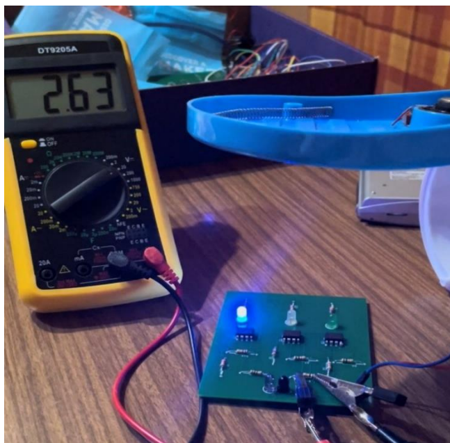
Slika 4.14. Detekcija plastičnog objekta plave boje na udaljenosti od 18 cm
