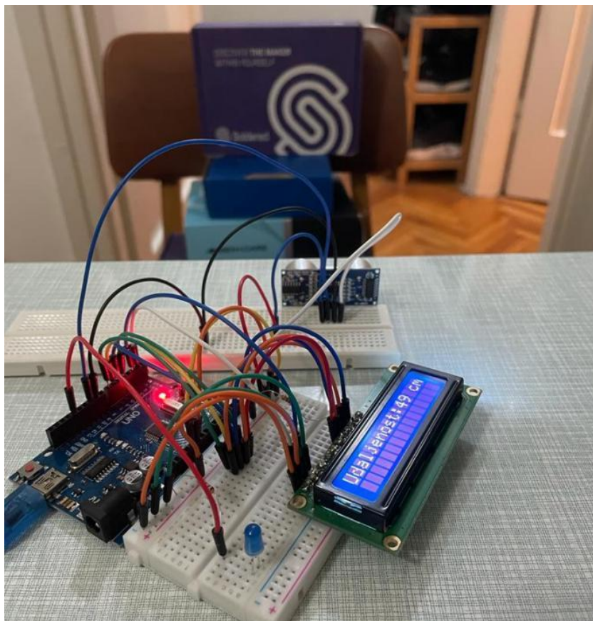
Slika 4.28. Mjerenje udaljenosti od objekta kartonske površine veličine 17x23 cm
