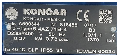
Slika 2.3. Natpisna pločica asinkronog motora
