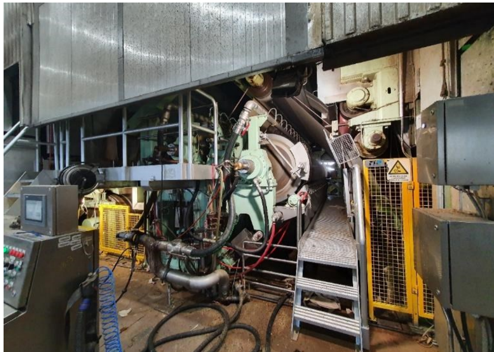
Slika 3.7. Lime preša (dodavanje škroba)(fotografirano 20. lipnja 2022)
