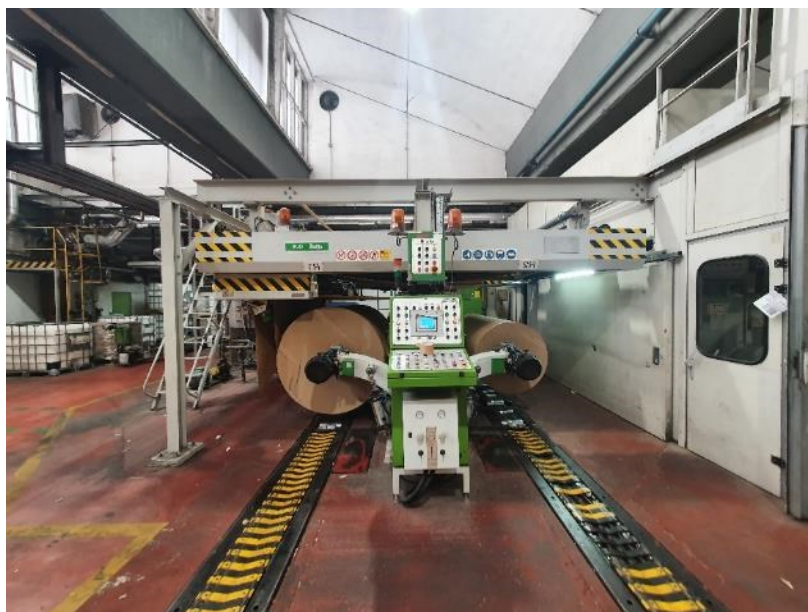
Slika 4.5. Odmatač prve glave (fotografirano 9. kolovoza 2022.)
