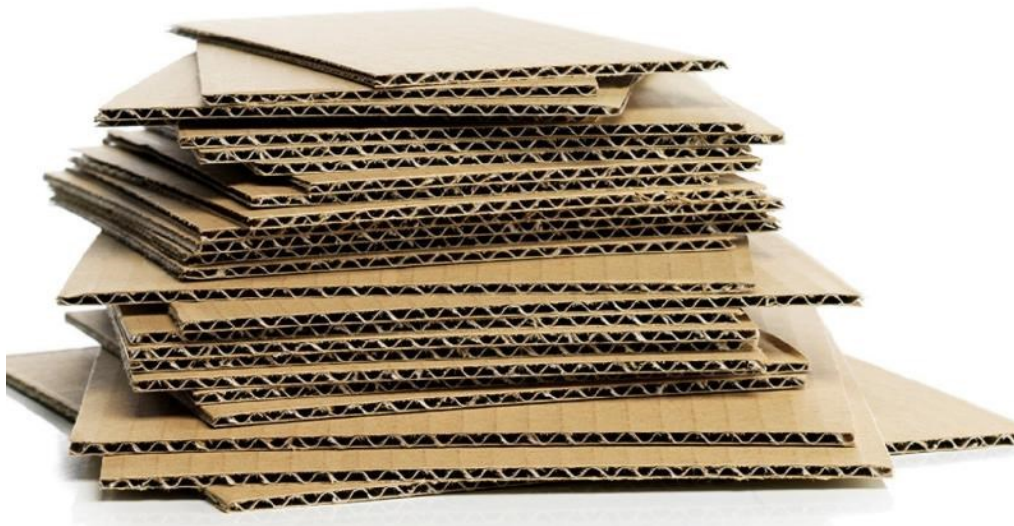
Slika 4.2. Troslojni karton (slika preuzeta iz literature [8])
