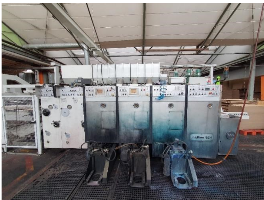
Slika 4.21. Agregati za bojanje i roto štanca Martin 924 (fotografirano 9. kolovoza 2022.)
