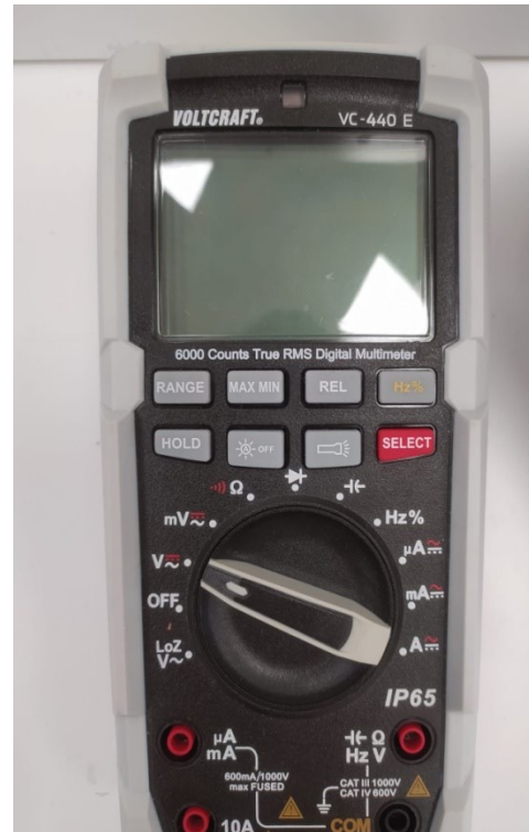
Slika 8.4. Univerzalni mjerni instrument „Voltcraft VC-440 E“
