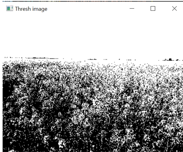
Slika 2.7. Primjer simple thresholding metode.
