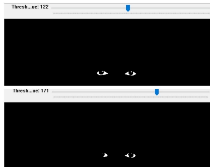
Slika 4.5. Korištenje klizne trake za mijenjanje granice binarizacije tijekom izvršavanja programa 2.dio.
