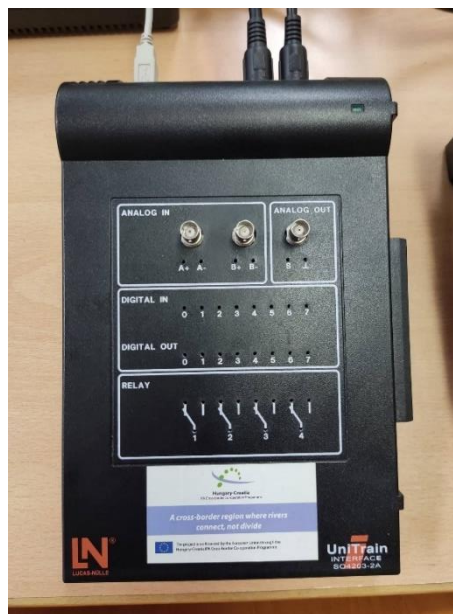
Sl. 4.2. Uni-Train mjerno sučelje
