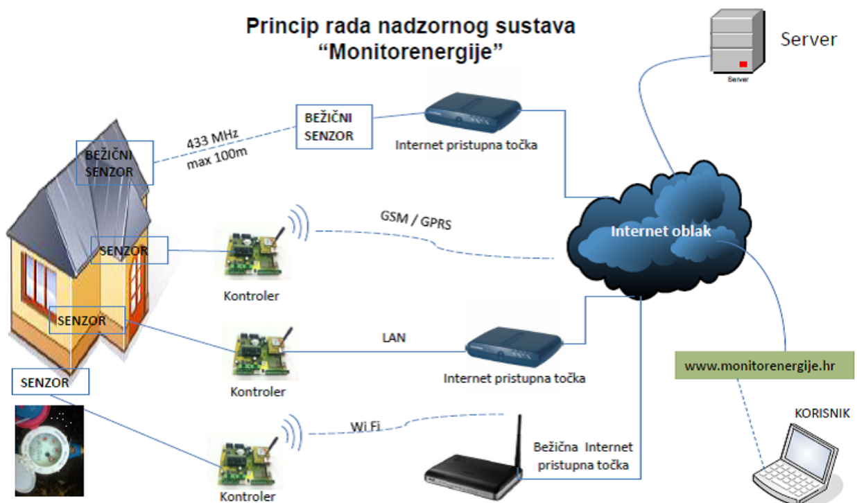
Slika 3.5. Princip rada nadzornog sustava Monitorenergije [30]
