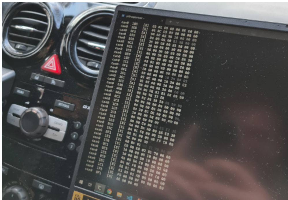
Slika 3.7: CAN poruke na zaslonu prijenosnog računala
