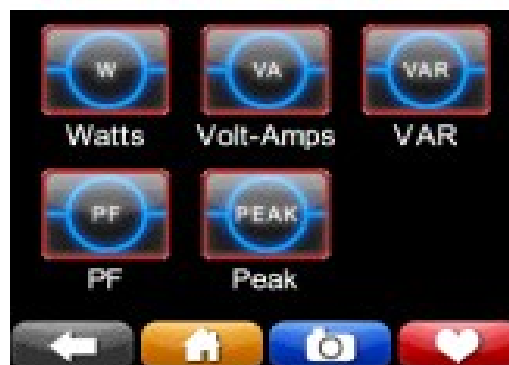
Slika 4.6 izbornik mjerenja snage i vršnih vrijednosti [2]
