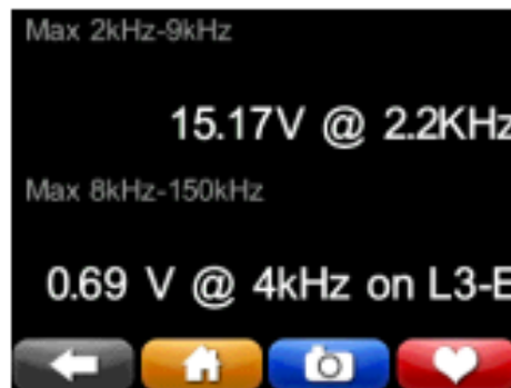
Slika 4.10 Mjerenje emisije smetnji [2]
