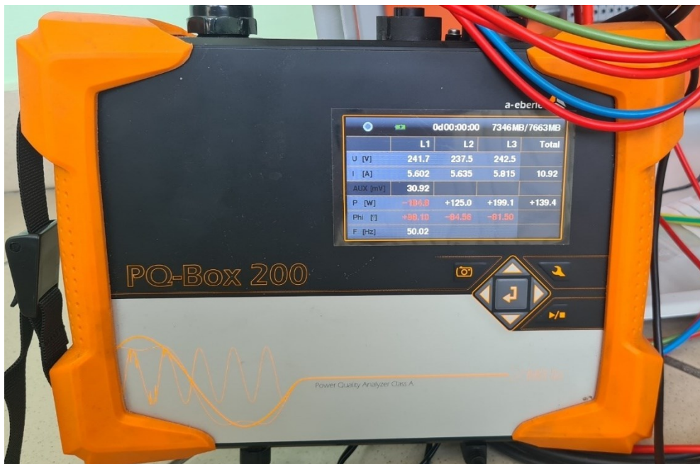
Slika 3.2 Prikaz mobilnog instrumenta za nadzor kvalitete PQ-Box 200
