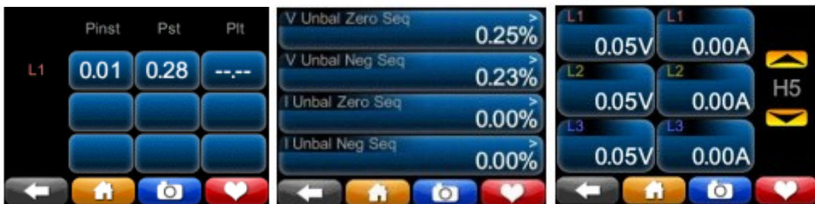
Slika 4.9 Prikaz flikera, nesimetrije i harmonika [2]
