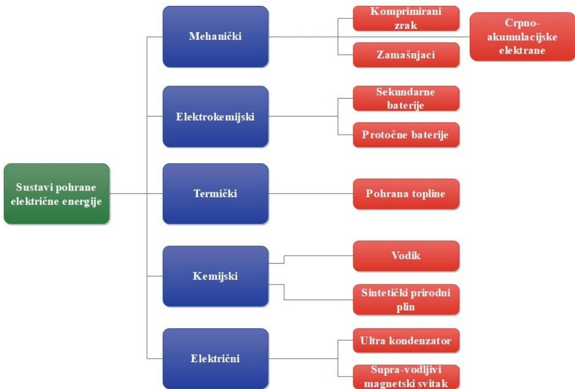
**Slika 3.1** Prikaz podjele sustava za pohranu električne energije [1]
