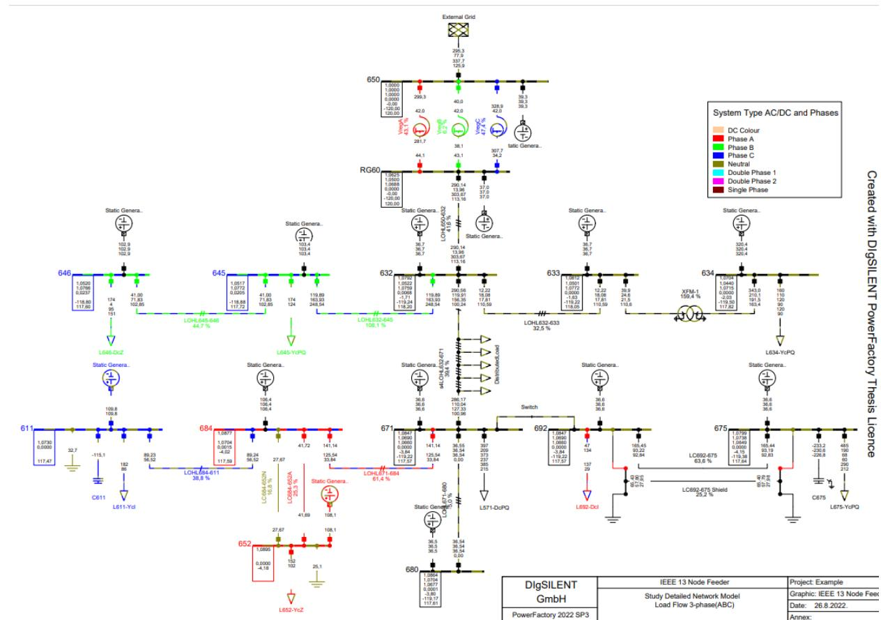
**Slika 6.34** Prikaz sheme sa spojenim baterijskim spremnicima na svim sabirnicama u sustavu
