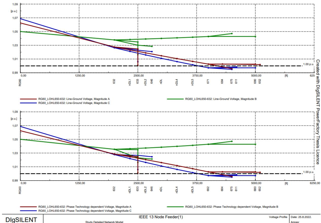
**Slika 6.13** Prikaz naponskog profila mreže sa spojenim baterijskim spremnikom na sabirnice 611 i 652
