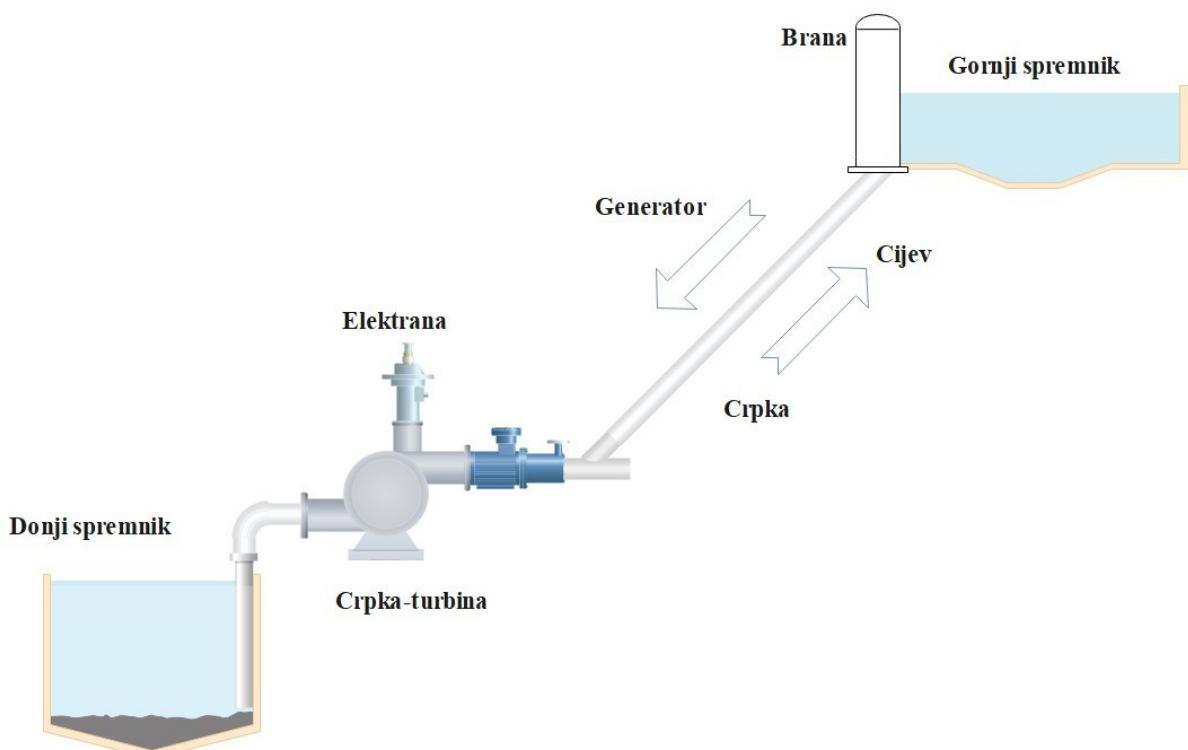
**Slika 3.3 „Princip rada akumulacijske hidroelektrane“ [1]**
