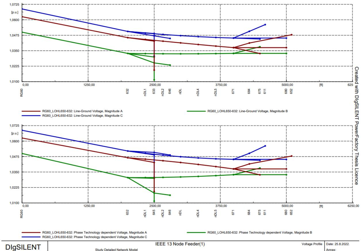
**Slika 6.23** Prikaz naponskog profila mreže sa spojenim baterijskim spremnikom na sabirnice 611, 652 i 675
