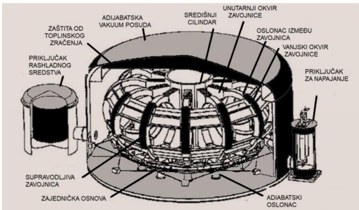
Slika 3.7 Prikaz pojedinih dijelova supravodljivog magnetskog svitka [3]
