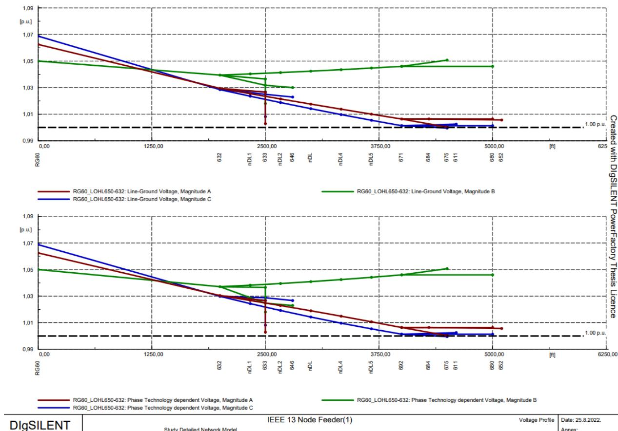
**Slika 6.15** Prikaz naponskog profila mreže sa spojenim baterijskim spremnikom na sabirnice 611, 652 i 675
