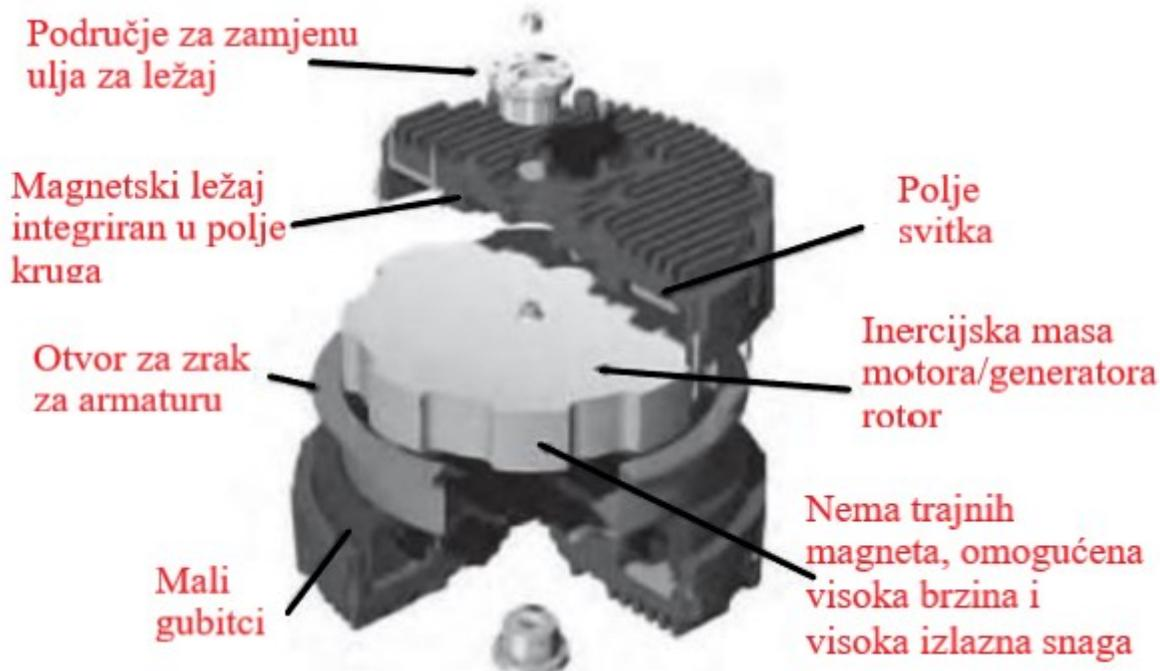
Slika 3.4 Prikaz zamašnjaka sa pripadajućim dijelovima [1]
