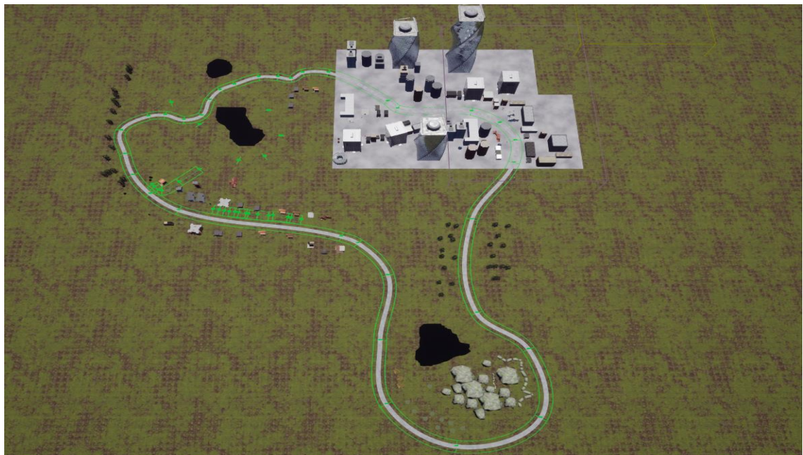
Sl. 3.20. Izgled mape Test2 načinjene u Unreal Engine alatu za testiranje implementiranog algoritma autonomne vožnje u obama simulatorima
