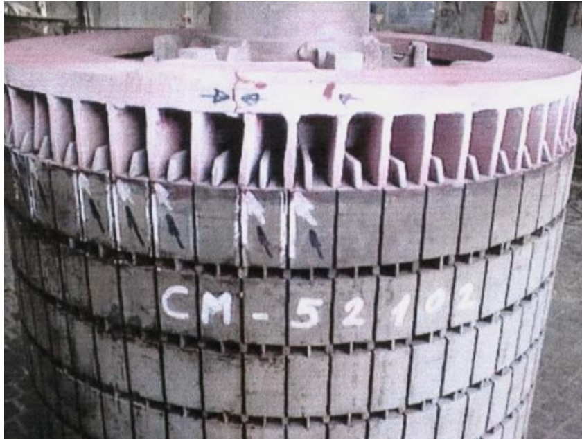
Slika 4.6 Detekcija pukotina pomoću penetranta [2]
