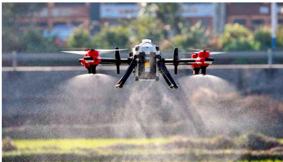
Slika 6.6. Tretiranje usjeva herbicidima i pesticidima uz pomic bespilotne letjelice
