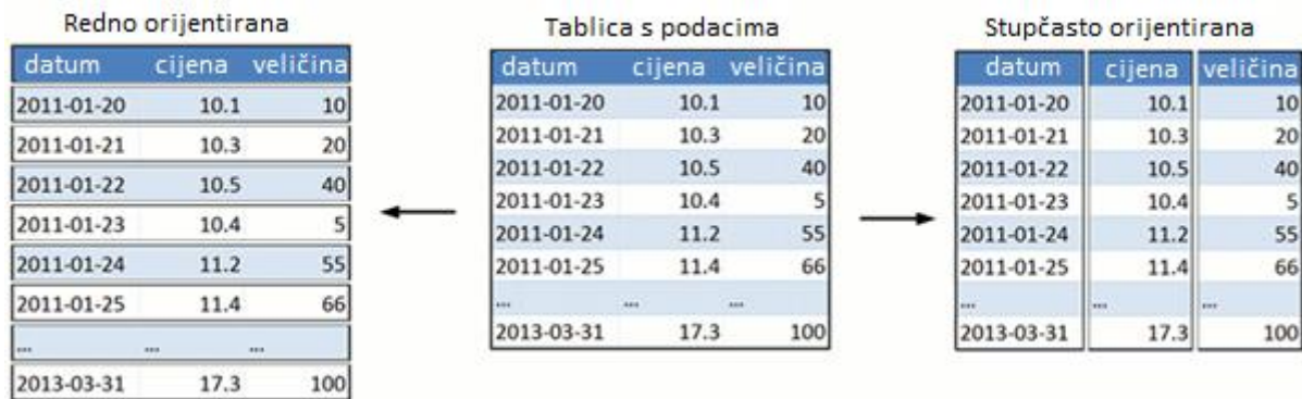
Sl. 2.2. Usporedba stupčaste i baze podataka usmjerene na redove
