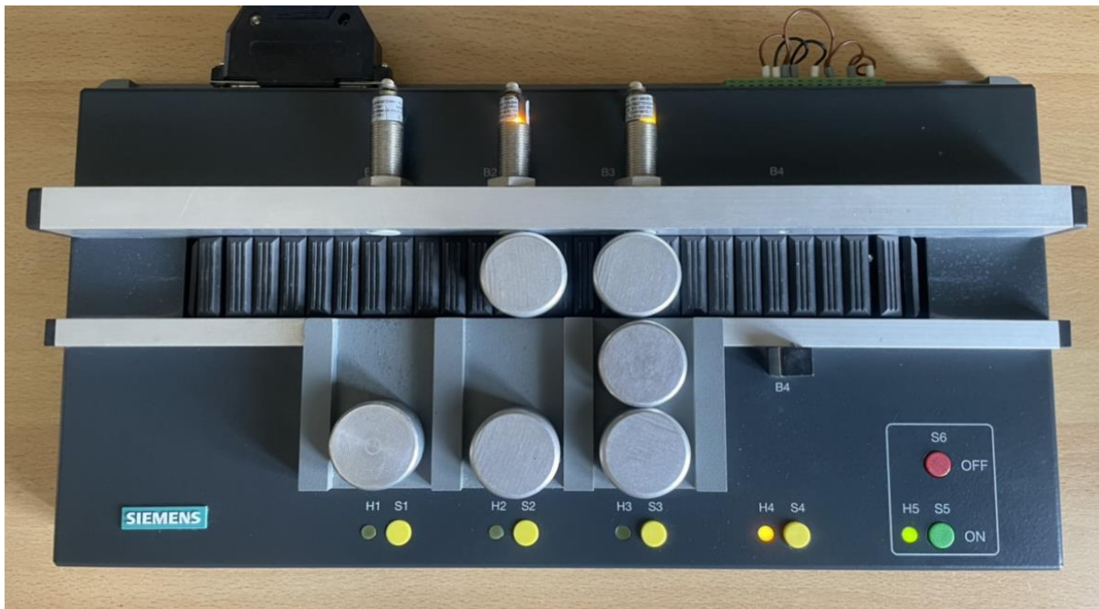
Slika 4.13. Pokretna traka – Status alarm H4
