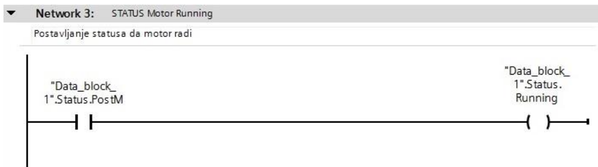
Slika 3.22 Postavljanje statusa da motor radi
