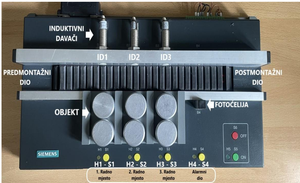
Slika 2.1. Maketa pokretne trake
