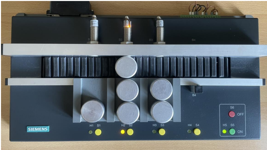
Slika 4.5. Pokretna traka – Status montažno mjesto H2
