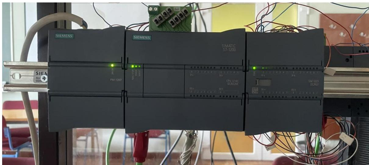
Slika 3.11 Modul napajanja, PLC S7 1200, U/I Signalni modul potrebeni za realizaciju praktičnog dijela diplomskog rada
