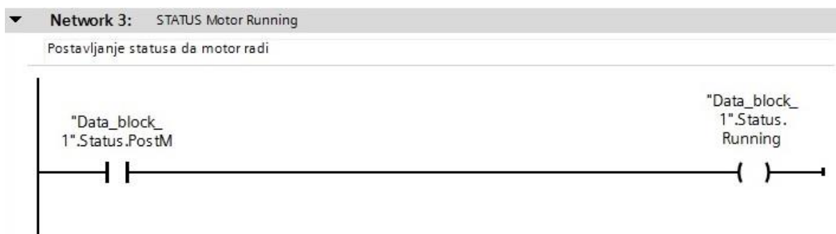
Slika 3.22 Postavljanje statusa da motor radi
