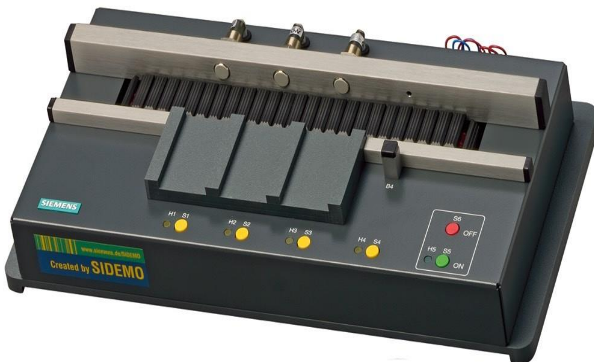
Slika 3.1. Maketa pokretne trake [1]
