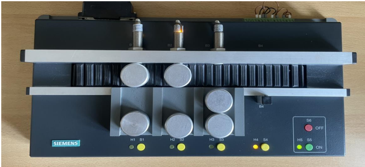
Slika 4.9. Pokretna traka – Status alarm H4
