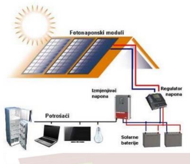
Slika 3.1.3. Samostalni fotonaponski sustav [28].
