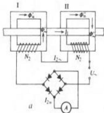
Jezgra je prethodno magnetizirana do indukcije zasićenja primarnom strujom  $I_1$ . Izmjenični napon  $U$  inducira izmjeničnu indukciju  $B^\sim$  u sekundarnim namotajima, čiji poluciklusi naizmjenično izvlače jednu jezgru iz zasićenja i tjeraju drugu jezgru dublje u zasićenje. Zbog izbacivanja jezgre iz zasićenja struja  $I_2$  teče kroz sekundarni svitak, kako bi se poništio amperzavoj  $I_1N_1$  koji jezgru drži u zasićenju. Za idealnu pravokutnu prirodu jezgre vrijedi sljedeća jednakost:
