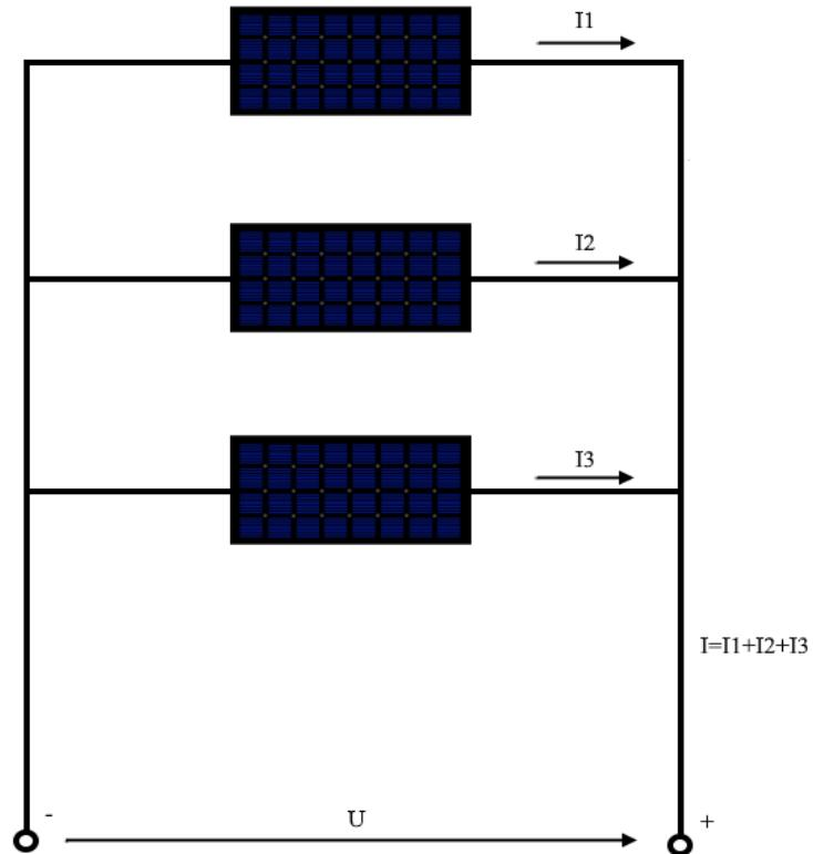
*Slika 3.3.3 Fotonaponski moduli spojeni paralelno*
