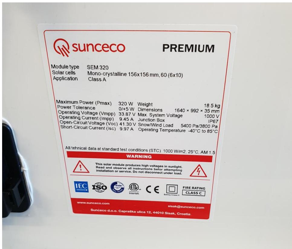
Slika 3.2.3 Naljepnica s tehničkim karakteristikama fotonaponskog modula
