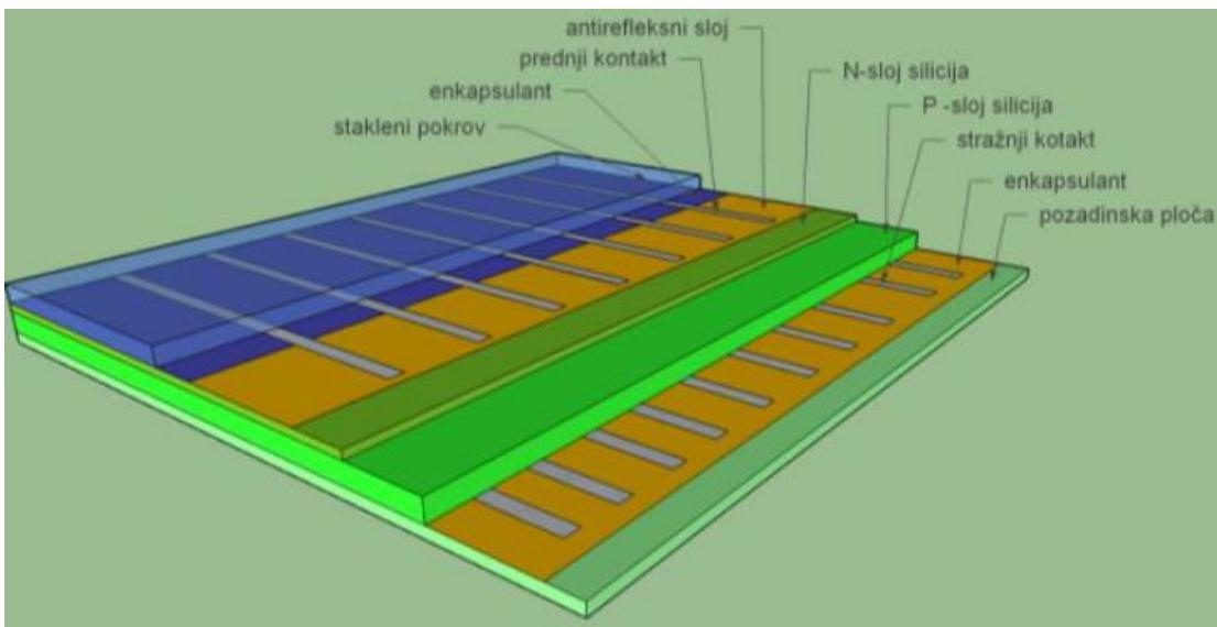
Slika 3.1.1 Dijelovi fotonaponske čelije [1]
