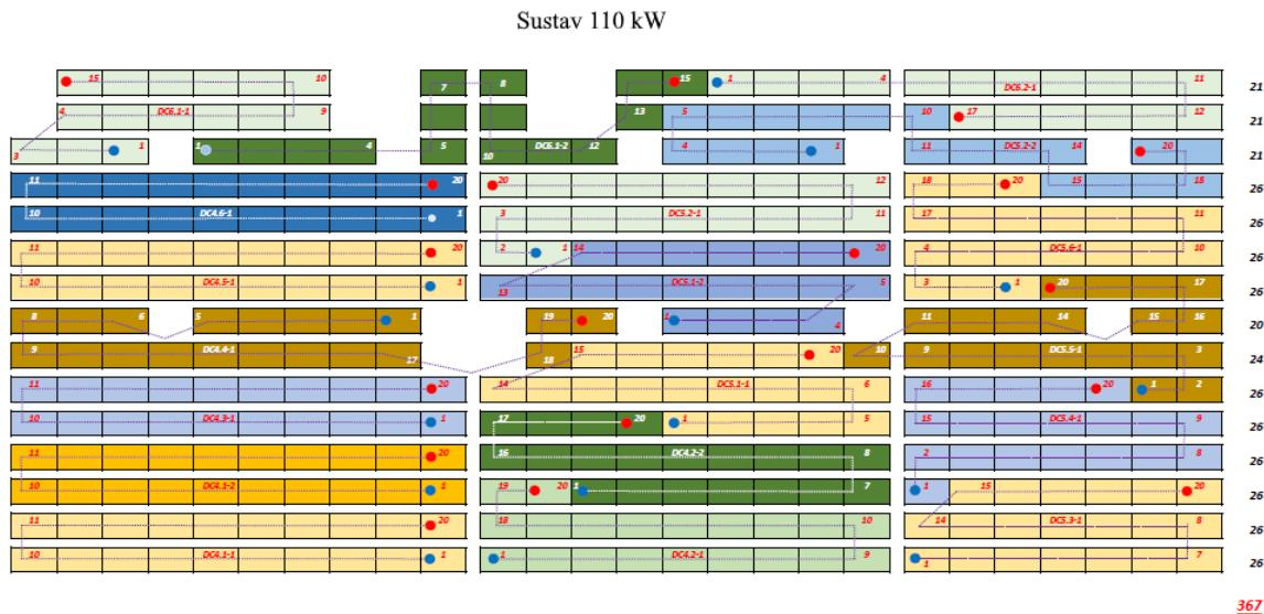
Slika 5.3.1 Raspored fotonaponskih nizova na fotonaponskom sustavu 110 kW
