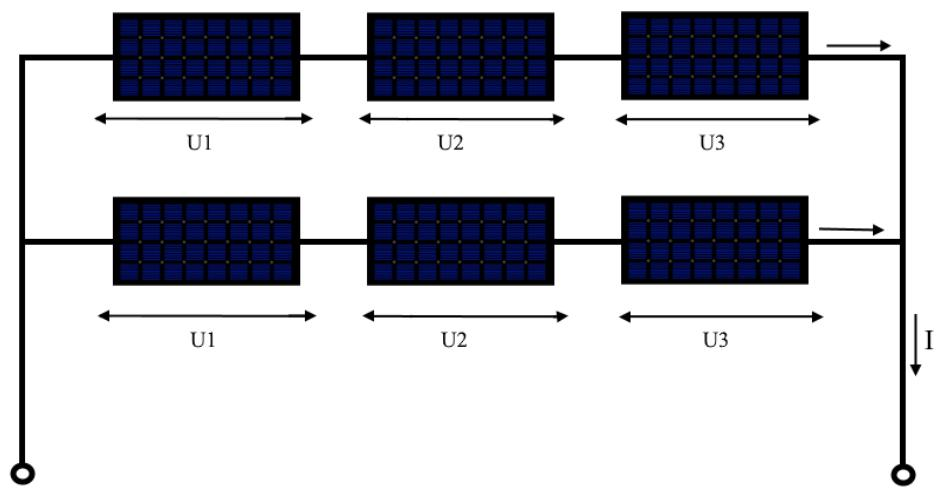
Slika 3.3.5 Kombinacija serijskog i paralelnog fotonaponskog niza
