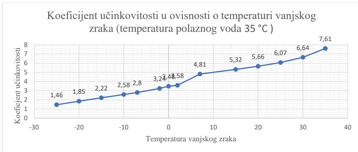
Slika 12: Koeficijent učinkovitosti u ovisnosti o temperaturi vanjskog zraka u režimu grijanja
