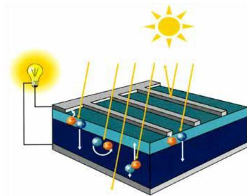
Slika 2: Nastajanje parova elektron-šupljina u fotonaponskoj ćeliji [4]
