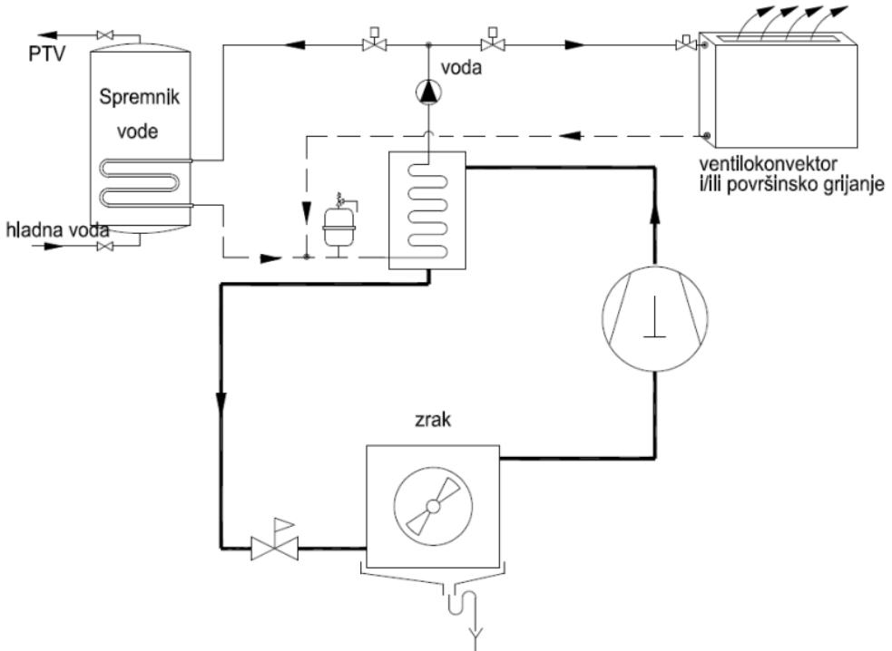
Slika 10: Shematski prikaz toplinske crpke zrak/voda [19]
