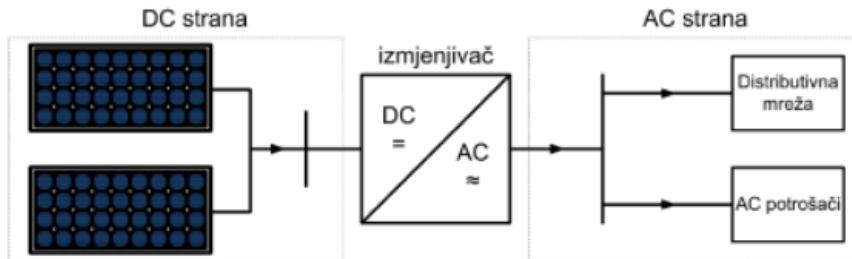
Slika 4: Pojednostavljena shema mrežnog fotonaponskog sustava [13]
