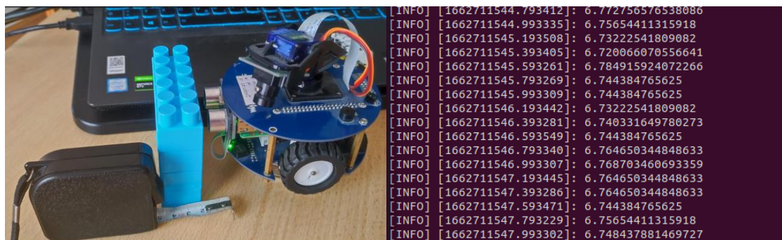
Slika 5.3 Greška prilikom računanja udaljenosti ultrazvučnog senzora
