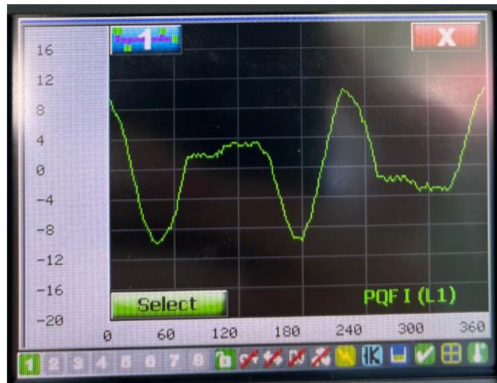
Slika 4.16. Filterska struja u fazi L1
