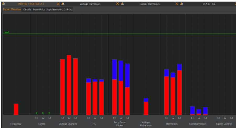
Slika 4.7. Pregled izvješća svih vrijednosti napona
