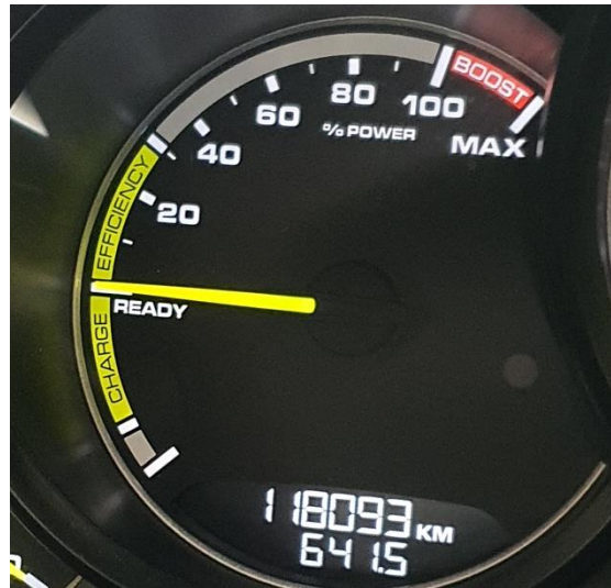
Slika 6.10 Pokazivač postotka stiskanja papučice gasa
