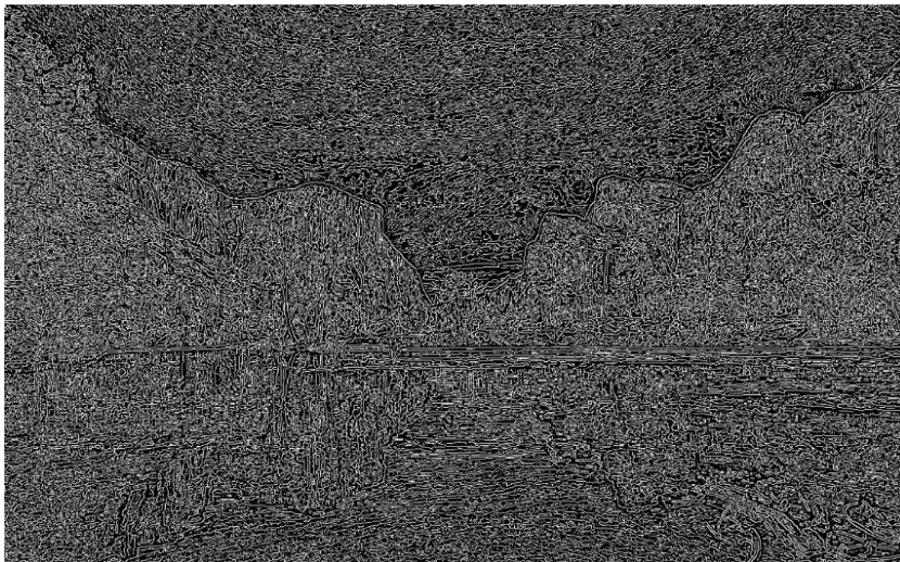
Slika 4.6. Fotografija jezera nakon primjene Canny Edge Detection algoritma s parametrima 0,0
