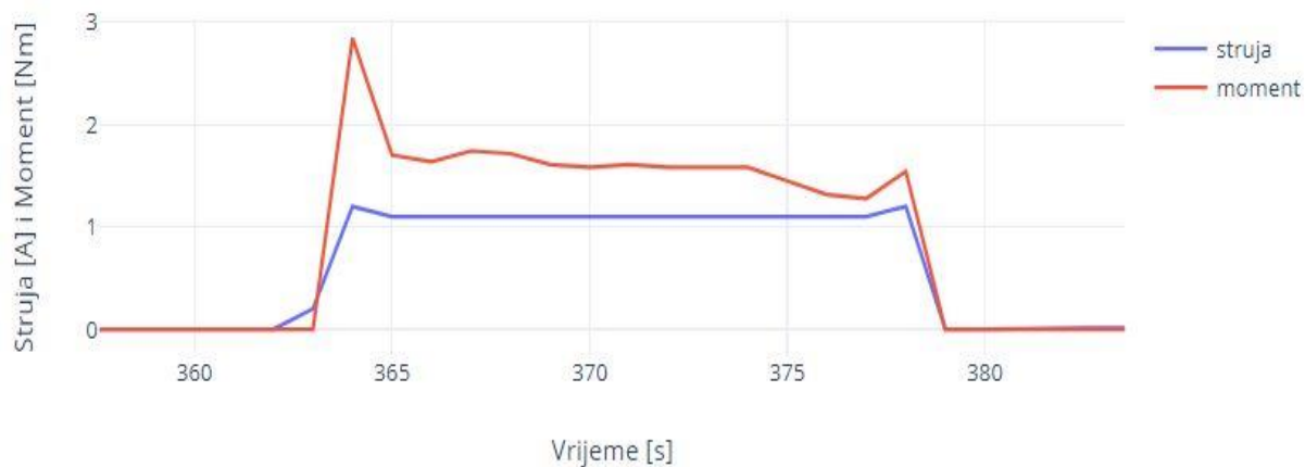
Slika 4.2 – Grafički prikaz struje i momenta sa rampom 5s bez tereta.
