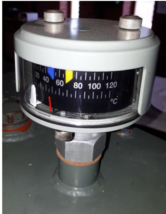
Sl. 3.16. Bimetalni termometar za vertikalnu ugradnju
