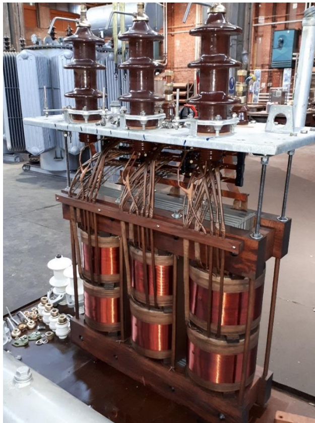
Sl. 3.11. Prikaz unutrašnjosti distributivnog transformatora
