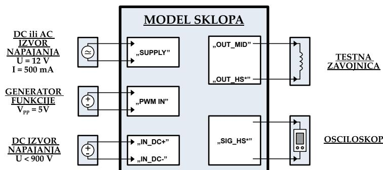
Sl. 4.1. Shema spajanja vanjskih uređaja na sklop
