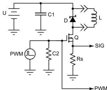
**Sl. 2.2.** Primjer sklopa za testiranje induktivnih komponenti
