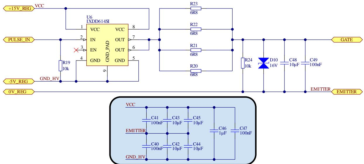
Sl. 3.11. Sklop s upravljačem gejta IGB tranzistora
