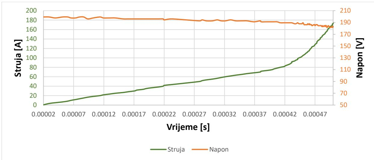
**Sl. 5.7.** Dijagram ovisnosti struje kroz zavojnicu (zeleno) i napona na energetskim kondenzatorima (oranžasto) o vremenu – željezna jezgra (180 A)
