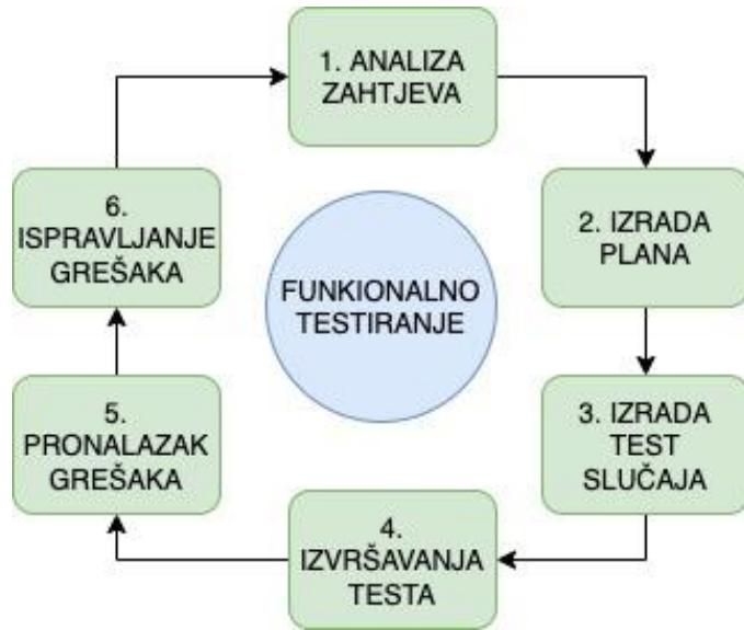
**Slika 2.3.** Proces funkcionalnog testiranja
