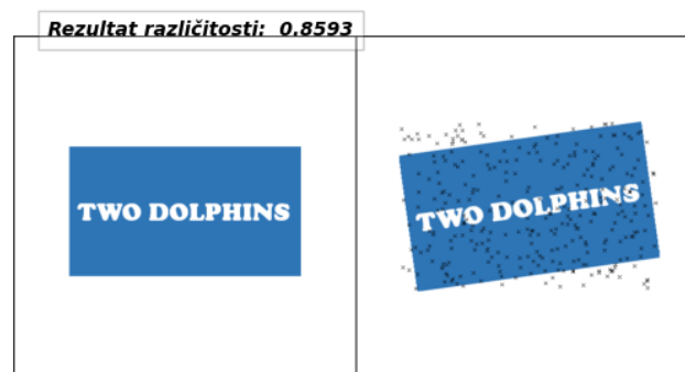
Slika 4.6 Primjer rezultata različitosti koje daje predložena neuronska mreža na slikama iz testne grupe 5 (a) rezultat različitosti za jednu pozitivnu sliku, (b) rezultat različitosti za jednu negativnu sliku
