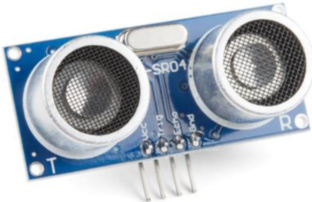
Slika 4.1. Prikaz ultrazvučnog senzora HC-SR04 [39].
