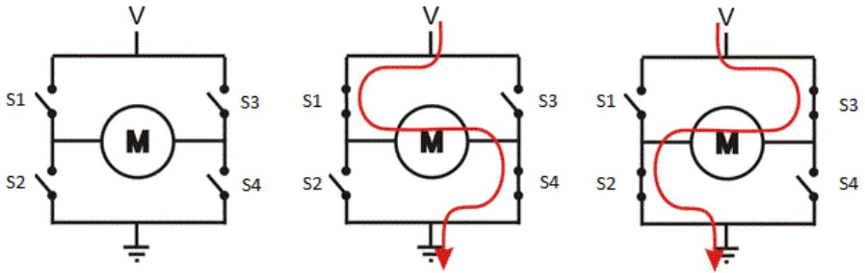
Slika 4.4. Prikaz spajanja prekidača s motorima [41].
