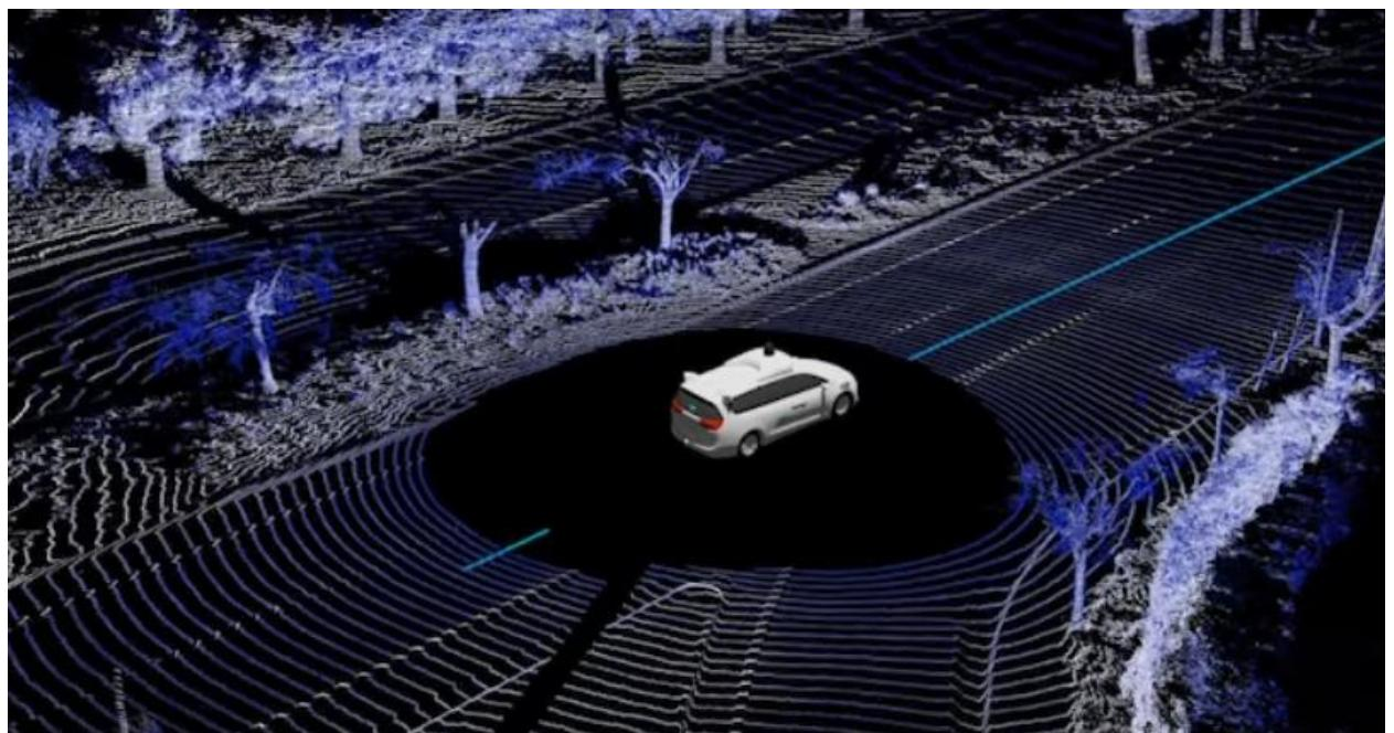
Slika 2.2. Korištenje LIDAR-a za kreiranje 3D slike okruženja [31].
