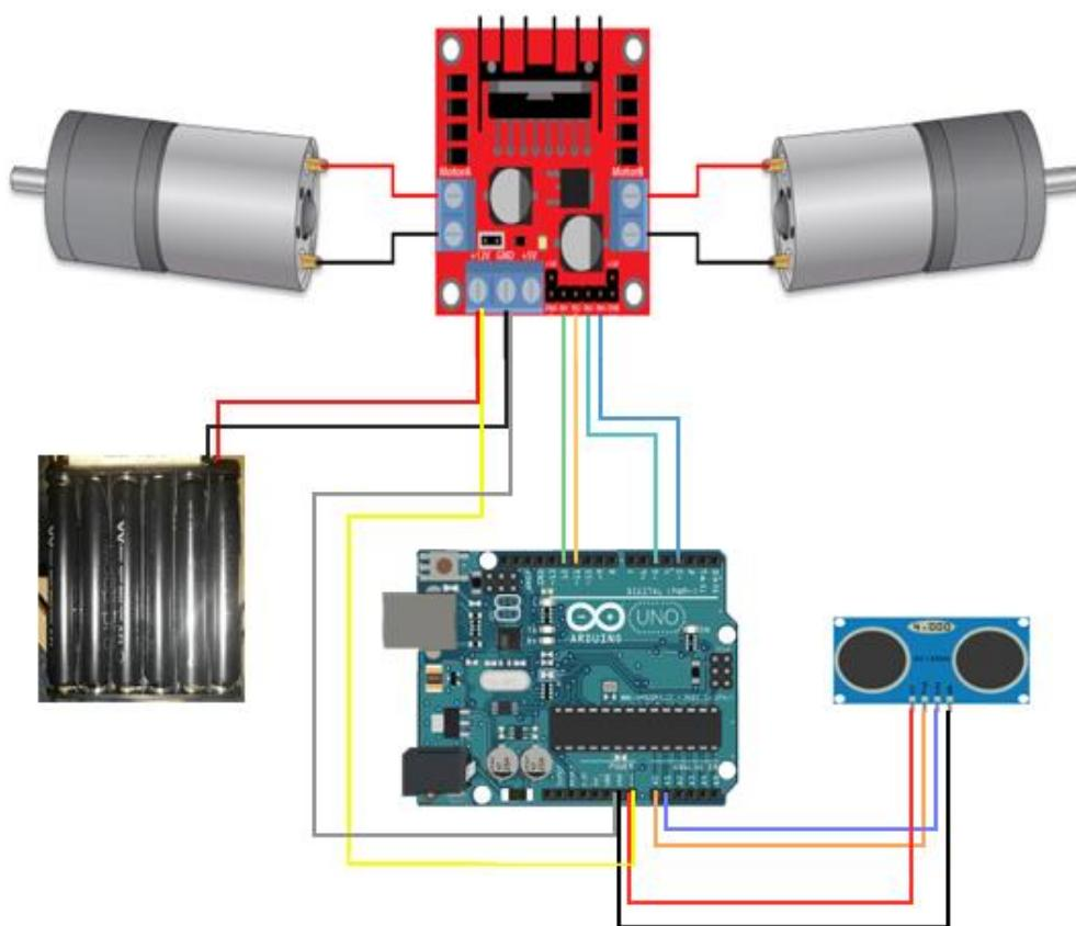
*Slika 4.5. Shema prve inačice sklopa prototipa modela autonomnog vozila.*
