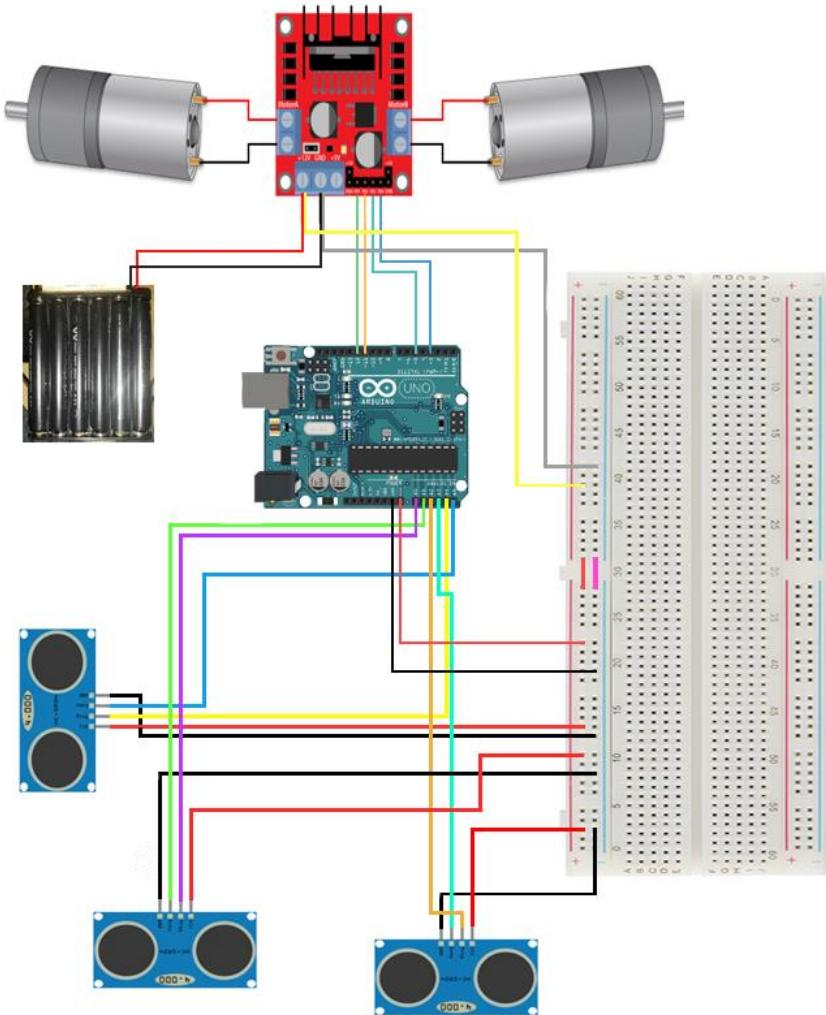
Slika. 4.6. Sklopošvska shema druge inačice prototipa modela autonomnog vozila.
