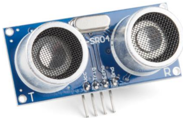
Slika 4.1. Prikaz ultrazvučnog senzora HC-SR04 [39].
